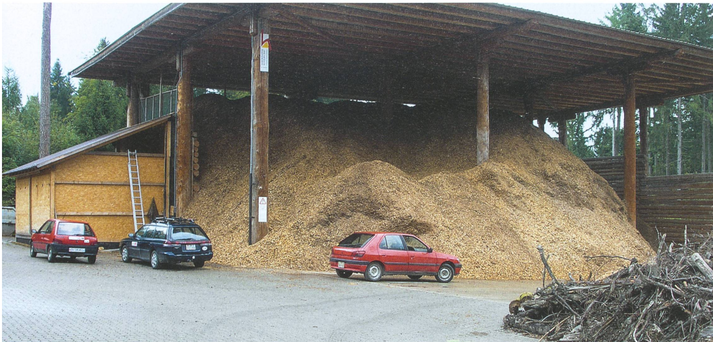
Ein zuverlässiges Angebot ist nur möglich, wenn mindestens ein Teil der Schnitzel in einem Schopf gelagert werden kann. Links im Bild eine Versuchsanlage zur Trocknung von Cheminéeholz mit Sonnenkollektor. Ziel ist es, den Trockner im März zu beschicken und Ende August die getrockneten Scheiter zu entnehmen. (Bilder: Ruedi Gnädinger)
