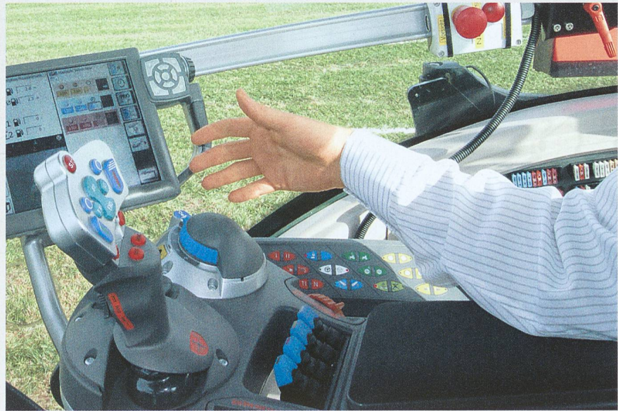
Variotronic in der neuen Baureihe 800 Vario. Eine Fülle von Bedien- und Kontrollelementen sind in Reichweite der rechten Hand und auf der rechten Armlehne positioniert.
