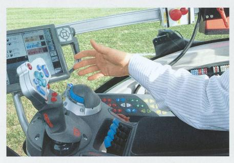
Variotronic in der neuen Baureihe 800 Vario. Eine Fülle von Bedien- und Kontrollelementen sind in Reichweite der rechten Hand und auf der rechten Armlehne positioniert.
