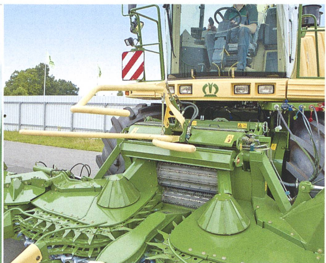
EasyCollect 753 mit flacher Bauweise und besonders leicht.
