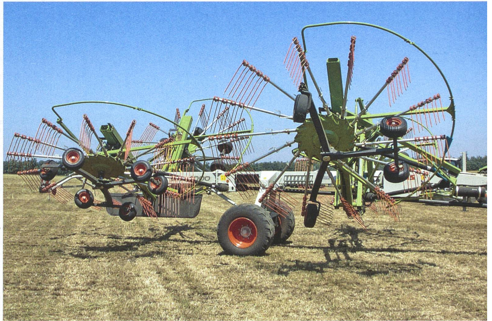
Trotz 15 m Arbeitsbreite lässt sich der neue Grossschwader LINER 4000 für den Strassentransport auf unter 4 m Höhe und 3 m Breite zusammenklappen (Foto: zVg).
