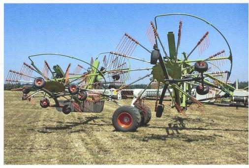
Trotz 15 m Arbeitsbreite lässt sich der neue Grossschwader LINER 4000 für den Strassentransport auf unter 4 m Höhe und 3 m Breite zusammenklappen (Foto: zVg).
