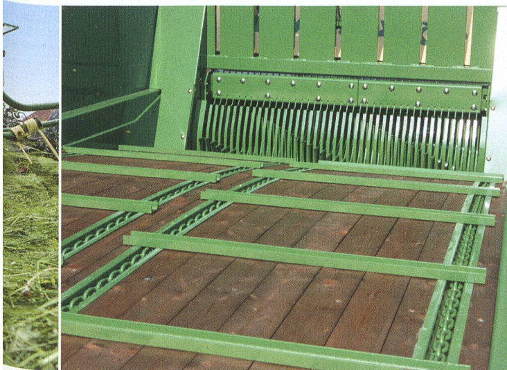
Abgesenkter Kratzboden auf dem MX-Ladewagen. (Bild: Ueli Zweifel)
