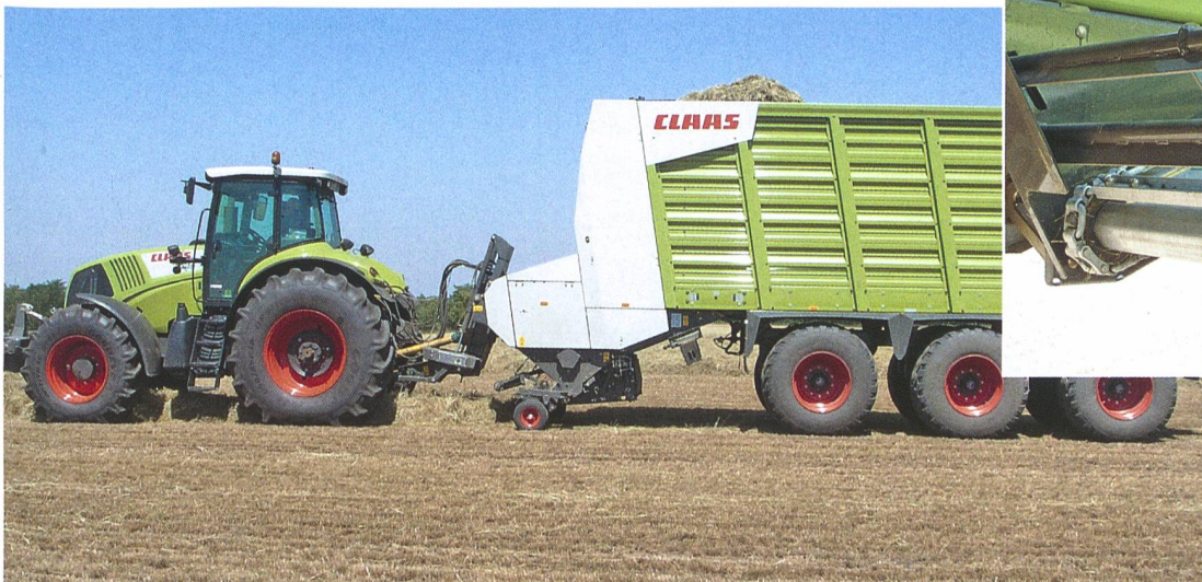
Die CARGOS-Kombiwagen lassen sich einerseits als vollwertige Rotor-Ladewagen und andererseits als effiziente Transportwagen beim Feldhäcksler-Einsatz einsetzen. (Fotos: Roger Stirnimann)
