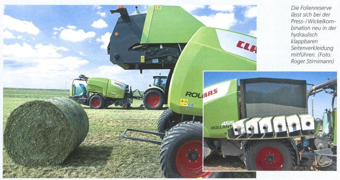
Die neuen Rundballenpressen ROLLANT 454 und 455 sind als klassische Fixkammer-Pressen und als Press-/Wickelkombination erhältlich. (Foto: zVq).
