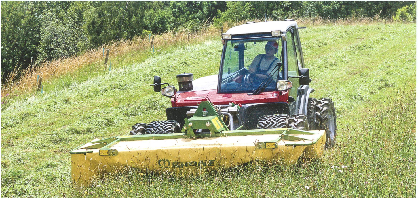
Mit nur ca. 600 kg eignet sich das EasyCut 32 M für den Hangeinsatz. (Firmenbilder)
