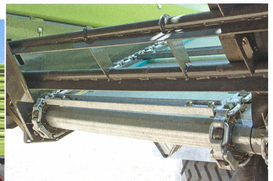
Der nach vorne um 50 cm abgesenkte Wagenboden im CARGOS vermindert die Antriebskräfte am Laderotor und schafft zusätzliches Ladevolumen.
