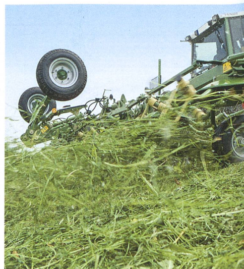
KWT 11.22/10: gezogener Kreiselzettwender für grosse Arbeitsbreiten ab 50 PS Traktorleistung.
