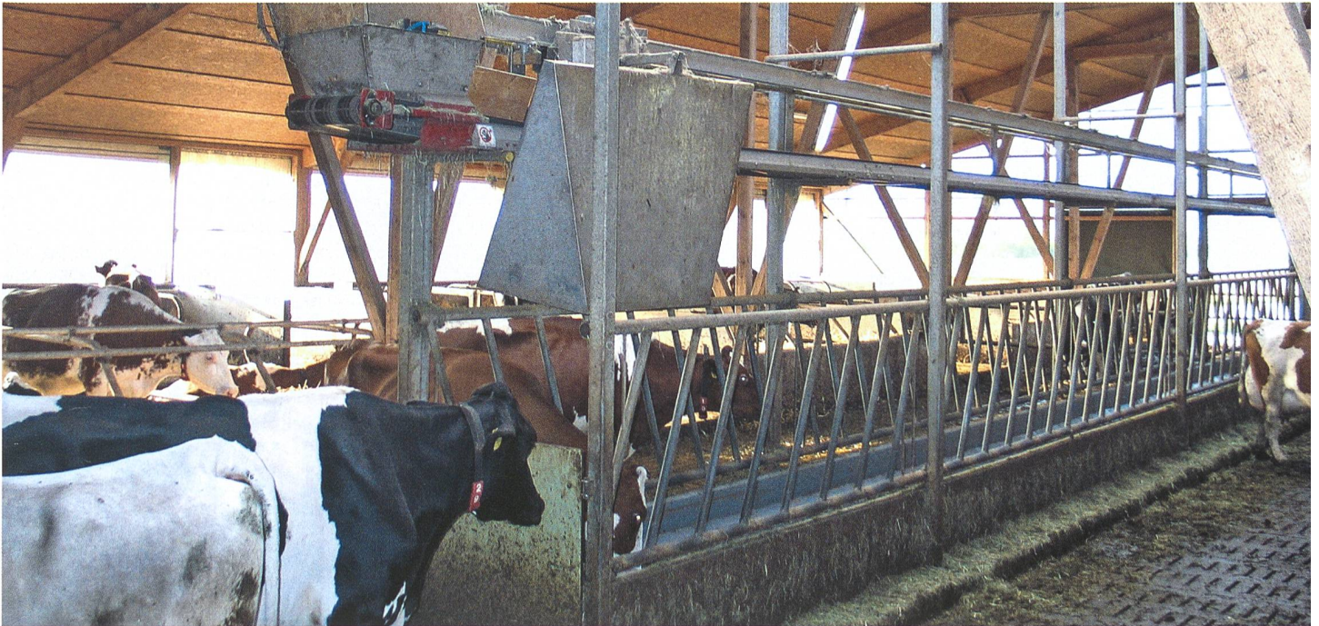
Automatisierte Fütterung im Thurgauer Betrieb von Hansjörg Uhlmann, Bonau: Die von den Vorratsstandorten selbsttätig zusammengeführten Futterkomponenten werden über der schmalen Futterachse verteilt. (Bild: Franz Nydegger)
