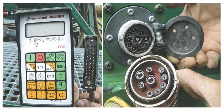
Bediengeräte einer Sämaschine mit analogem, vieladrigem Stecker (links) und Isobus-Verbindung für den digitalen Datenverkehr zwischen Traktor und Anbaugerät. (Bilder: Bernhard Streit)
