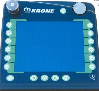
Isobus-Bedienterminal vom CCI (Competence Center Isobus) in der Ausführung von Krone. Dieser Terminal verfügt über Touchscreen, Bedientasten und Stopknopf sowie zusätzliche Schnittstellen über WLAN, Bluetooth, Ethernet und einen weiteren CAN-Bus.
