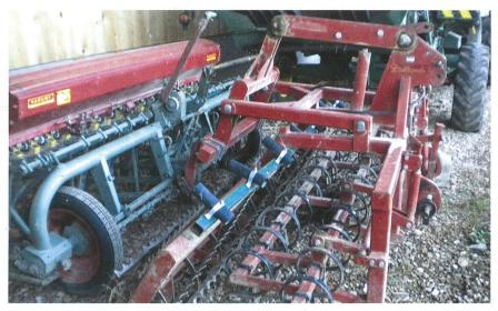
Säkombination «hausgemacht»: Verwendet wurden eine Occasion-Sämaschine von Nodet und eine Aufsattelvorrichtung auf einer Federzinkenegge
