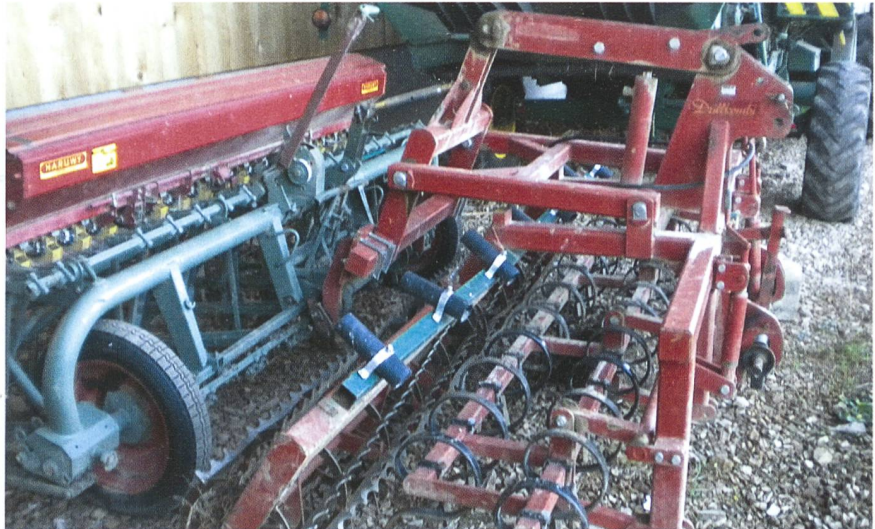
Säkombination «hausgemacht»: Verwendet wurden eine Occasion-Sämaschine von Nodet und eine Aufsattelvorrichtung auf einer Federzinkenegge
