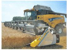
Ultralight 800 (Biso Schrattenecker GmbH): Das Schneidwerk Ultralight 800 mit einer Arbeitsbreite von 12 m ist aus speziellen, zum Patent angemeldeten Aluminium-Hohlblockelementen gefertigt. Sämtliche Einstellungen zur Anpassung an verschiedene Erntebedingungen erfolgen entweder elektrohydraulisch oder an zentralen Spindeln. Das auf grössere Arbeitsbreiten erweiterbare Schneidwerk in Leichtbauweise ist eine zukunftsweisende Weiterentwicklung.
