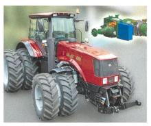
Belarus 3023 (Traktorenwerk Minsk): Der 220 kW-Standardtraktor hat einen dieselelektrischen Antrieb mit einer modernen Steuerungselektronik und gutem Wirkungsgrad. Die Frontzapfwelle wird elektrisch angetrieben und ist folglich auch in der Drehzahl weitgehend unabhängig vom Verbrennungsmotor. Aus dem internen Gleichstromhochspannungsnetz können bis zu 172 kW elektrische Leistung an externe Verbraucher mit entsprechendem Leistungsbedarf abgegeben werden.
