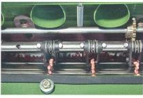
einer Einzelkornsämaschine die Vereinzelungsqualität durch eine automatische Regelung der Abstreiferposition gewährleistet. Dadurch wird die Arbeitsqualität bei der Maisaussaat insbesondere bei hohen Fahrgeschwindigkeiten wesentlich verbessert.
