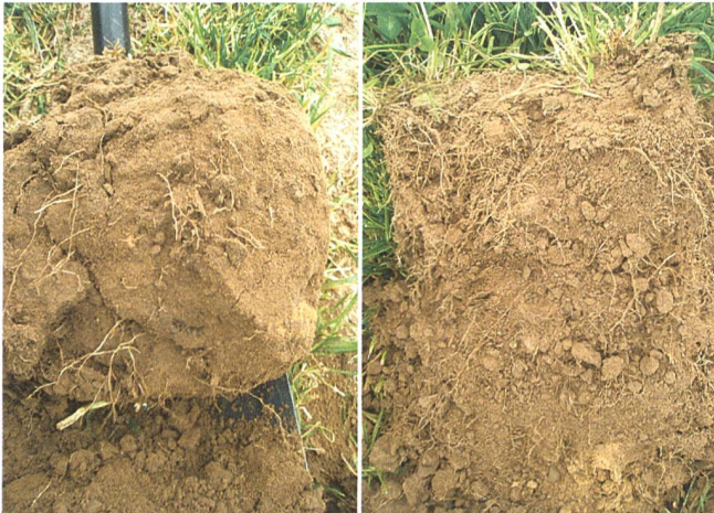
Abb. 1: Spatenprobe im CTF-Feld in Dänemark. Links in der Fahrspur Verdichtungen und schlechte Durchwurzelung, rechts im unbefahrenen Bereich krümelige Bodenstruktur mit starker Durchwurzelung. (Bilder: Agroscope ART)
