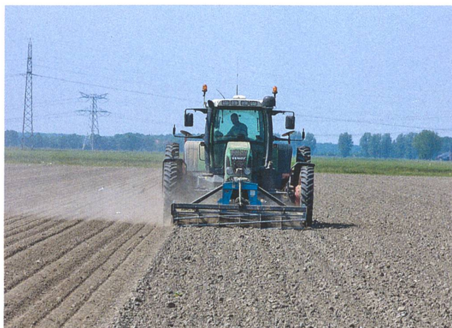
Abb. 2: Herkömmliche CTF-Systeme brauchen einheitliche Spurbreiten. Traktor mit verbreiterter Spur bei Einzelkornsaat im Gemüsebau in Holland.
