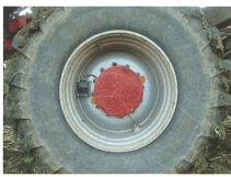
Soil Load Monitor (GRASDORF WEN-**NEKAMP GmbH):** Ein Ultraschallsensor in der Felge misst kontinuierlich die Reifeneinfederung und liefert somit eine Kennzahl, nach der last- und geschwindigkeitsabhängig jeweils der minimale Reifendruck eingestellt werden kann.
