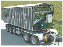
Fliegl-Hubdach Toplift (Fliegl): Schüttgut lässt sich mit der hydraulisch betätigten Abdeckhaube schnell und sicher abdecken. Dies bedeutet nicht nur mehr Sicherheit für andere Verkehrsteilnehmer; da das manuelle Abdecken in bis zu 4 m Höhe entfällt, erhöht sich auch die Sicherheit des Anwenders.
