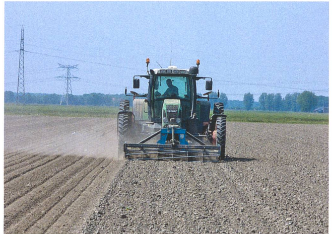
Abb. 2: Herkömmliche CTF-Systeme brauchen einheitliche Spurbreiten. Traktor mit verbreiterter Spur bei Einzelkornsaat im Gemüsebau in Holland.
