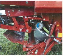
Messerschleifen am Ladewagen / Intelligente Ladewagenkombination (Pöttinger): Das Schleifen von Ladewagen-Messern ist bisher als zeitaufwändige und unergonomische Arbeit bekannt. Pöttinger ist es gelungen, einen Schleifautomaten für Einzelmesser in Ladewagenschneidwerken zu entwickeln. Der vollautomatisierte Schleifvorgang ist während der Transportfahrt mehrmals täglich möglich.
