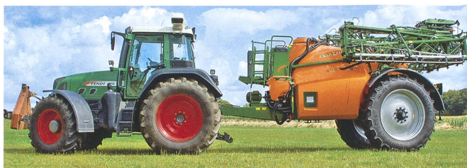
UX eSpray: Amazone-Pflanzenschutzgeräte mit elektrischem Antrieb.
