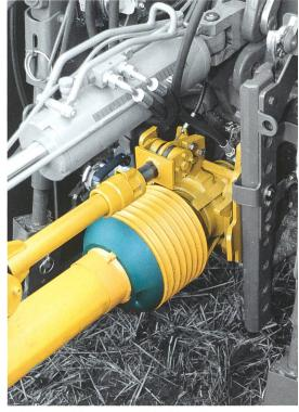
Walterscheid: Automatische Kupplung der Zapfwelle.
