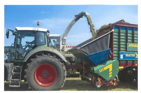
Erhöhung der Ladekapazität durch Vorpressung im Erntewagen.
