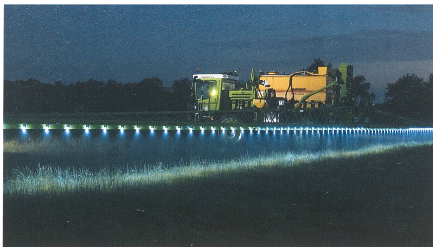
GPS-Technik kombiniert mit LED-Lichtquellen erlaubt eine sichere Behandlung im Dunkeln.
