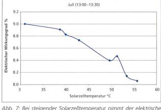
Abb. 7: Bei steigender Solarzelltemperatur nimmt der elektrische Wirkungsgrad mit durchschnittlich 0,4% pro °C ab. Die Bezugsebene ist hier die Sonnenstrahlung auf einer um 20° gegen Süden geneigten Dachfläche.
