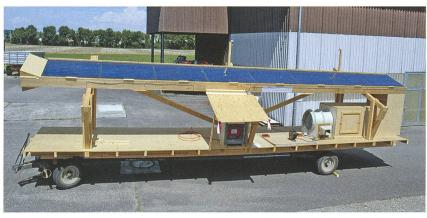
Abb. 3: Die Versuchsanlage (PV-Anlage) der ART besteht aus acht Photovoltaikmodulen im Dach integriert (20°). Ein Ventilator (unten rechts) mit vorgeschaltetem Messventilator erlaubt eine stufenlose Luftgeschwindigkeitsregelung zwischen 1 und 7 m/s.
