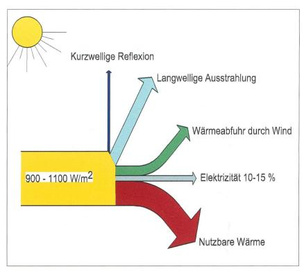
Abb. 2: Von der Sonnenenergie, die auf ein Solarmodul fällt, wird nur ein kleiner Teil (10–15%) in Elektrizität umgesetzt. Etwa 40 bis 50% kann als Wärme genutzt werden, der Rest wird durch den Wind abgeführt oder strahlt ab.
