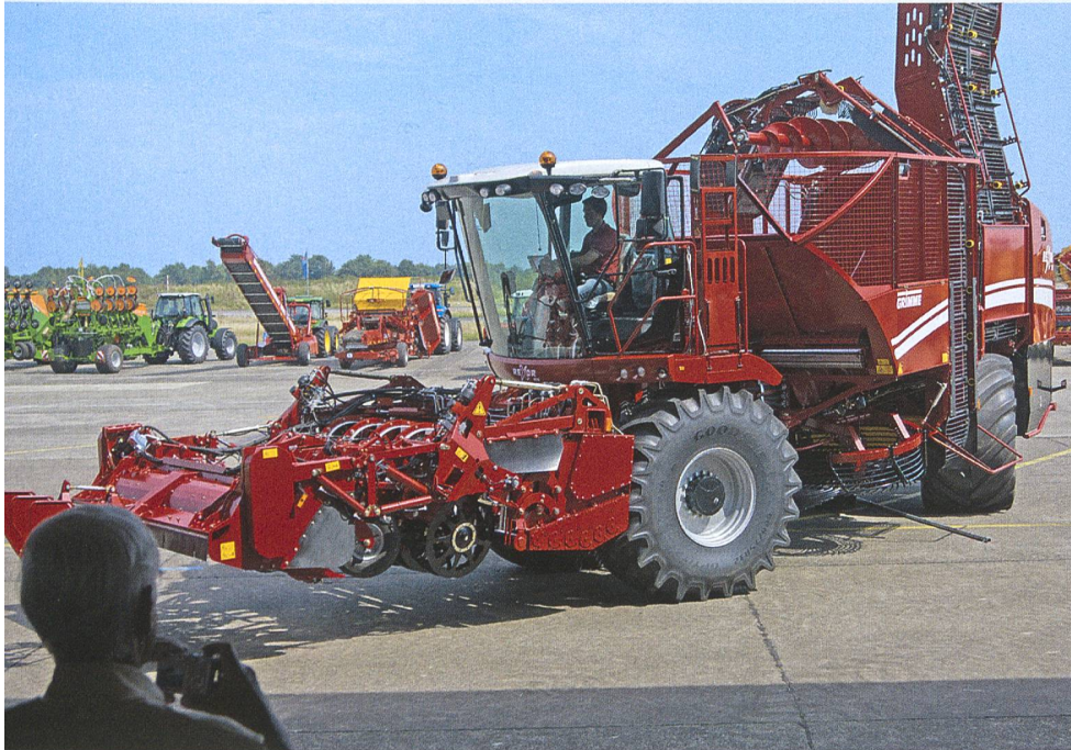
Rexor 620 mit Knicklenkung und Achslenkung für enge Wenderadien. (Bild: Ueli Zweifel).
