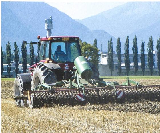
Die Flächenleistung kann durch grössere Arbeitsbreiten oder durch höhere Fahrgeschwindigkeit erhöht werden.
