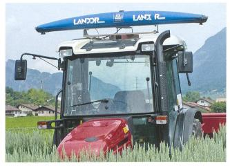
Die teilflächenspezifische N-Düngung bedingt in der Regel fahrzeuggestützte Sensoren in Verbindung mit einem entsprechend ausgerüsteten Düngerstreuer.
