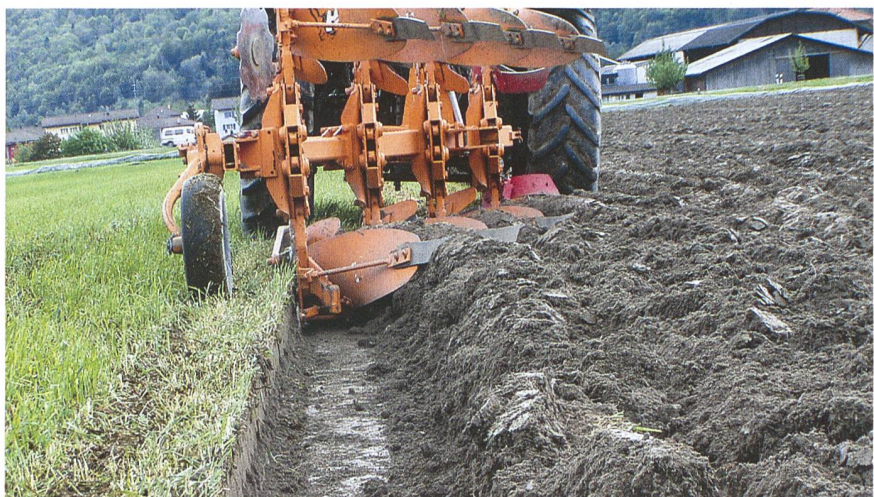
Pflugeinstellung: Starke Reibung der Anlage an der Furche erhöht den Verschleiss und steigert den Treibstoffverbrauch um bis zu 20 Prozent.
