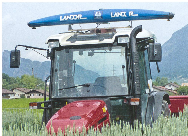
Die teilflächenspezifische N-Düngung bedingt in der Regel fahrzeuggestützte Sensoren in Verbindung mit einem entsprechend ausgerüsteten Düngestreuer.
