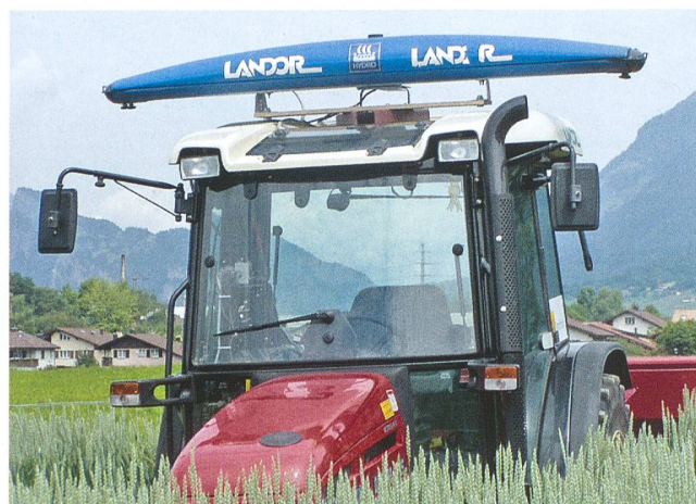
Die teilflächenspezifische N-Düngung bedingt in der Regel fahrzeuggestützte Sensoren in Verbindung mit einem entsprechend ausgerüsteten Düngerstreuer.
