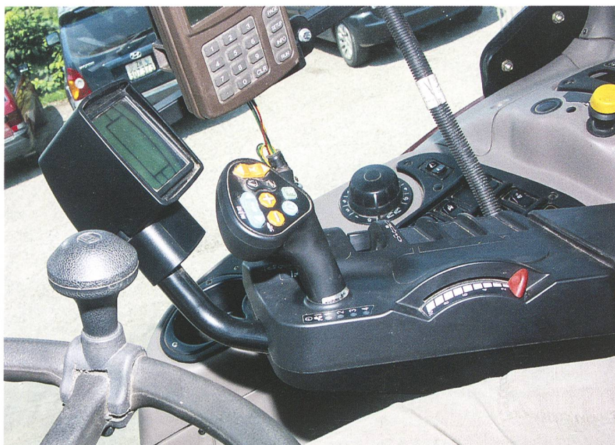
Alles in der Armlehne: Multicontroller V mit Gang- und Gruppenschaltung, Reversierung, sowie Dreipunkt-Hydraulik und Hydraulikventile.
