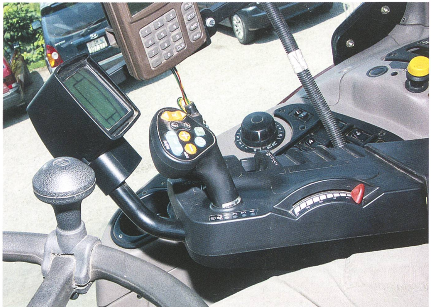
Alles in der Armlehne: Multicontroller V mit Gang- und Gruppenschaltung, Reversierung, sowie Dreipunkt-Hydraulik und Hydraulikventile.
