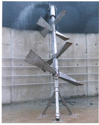
Axial- oder Tangentialrührwerk. (Werkbild)
