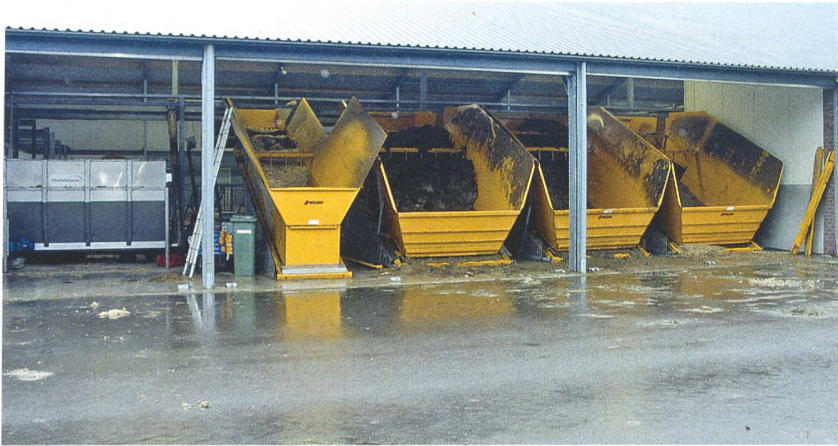
Abb. 10: Der Futtermittelvorbereitungsraum (Mullerup) enthält mehrere Dosierbehälter für die einzelnen Komponenten. Es sind Behälter für Silagen sowie für Mineralstoffe und teigförmige oder flüssige Komponenten erhältlich.
