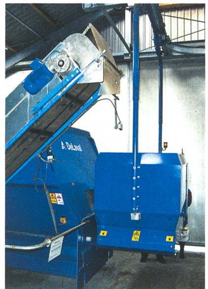
Abb. 9: Ein stationärer Mischer (DeLaval) erstellt die Mischration. Anschliessend beschickt die Beschickanlage den Futterverteilwagen. Sensoren überwachen die korrekte Dosierung.
