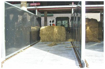
Abb. 11: Das Dosiersystem von Triomatic besteht aus einem Schneidrahmen (links) einem Wiege- und Förderband und mehreren Vorratsund Zuführtischen für die Futterkomponenten (rechts). Der Schneidrahmen kann Siloblöcke und Grossballen verarbeiten und dabei das Futter auf die gewünschte Länge schneiden.
