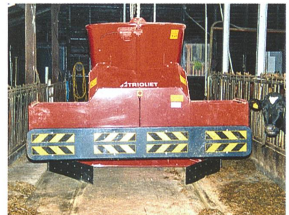
Abb. 8: Der schienengeführte Vertikalmischer (Triomatic) verfügt über zwei Mischschnecken und 3 Kubikmeter Fassungsvermögen. Aufgrund seiner Breite von 1,35 Meter und einer Länge von 3,13 Meter benötigt er eine genügende Futtertischbreite.
