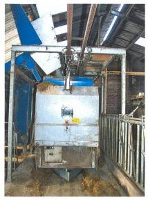
Abb. 6: Der RobotFeeder (Pellon) holt die Futterkomponenten bei den Futterbehältern ab und mischt sie bereits während der Beschickung mittels eines Mischkettensystems und einer horizontalen Schnecke. Über die zentrale Schnecke und ein Förderband erfolgt dann der Futterauswurf zur rechten oder linken Seite des Roboters.
