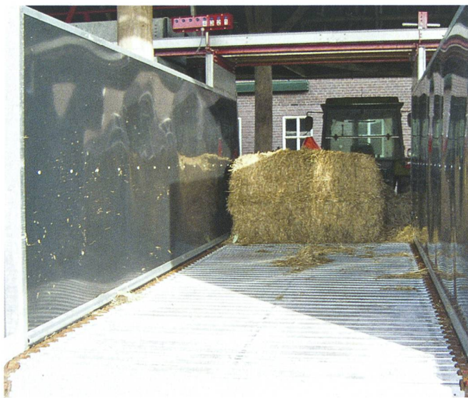
Abb. 11: Das Dosiersystem von Triomatic besteht aus einem Schneidrahmen (links) einem Wiege- und Förderband und mehreren Vorrats- und Zuführtischen für die Futterkomponenten (rechts). Der Schneidrahmen kann Siloblocke und Grossballen verarbeiten und dabei das Futter auf die gewünschte Länge schneiden.
