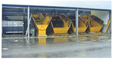
Abb. 10: Der Futtervorbereitungsraum (Mullerup) enthält mehrere Dosierbehälter für die einzelnen Komponenten. Es sind Behälter für Silagen sowie für Mineralstoffe und teigförmige oder flüssige Komponenten erhältlich.
