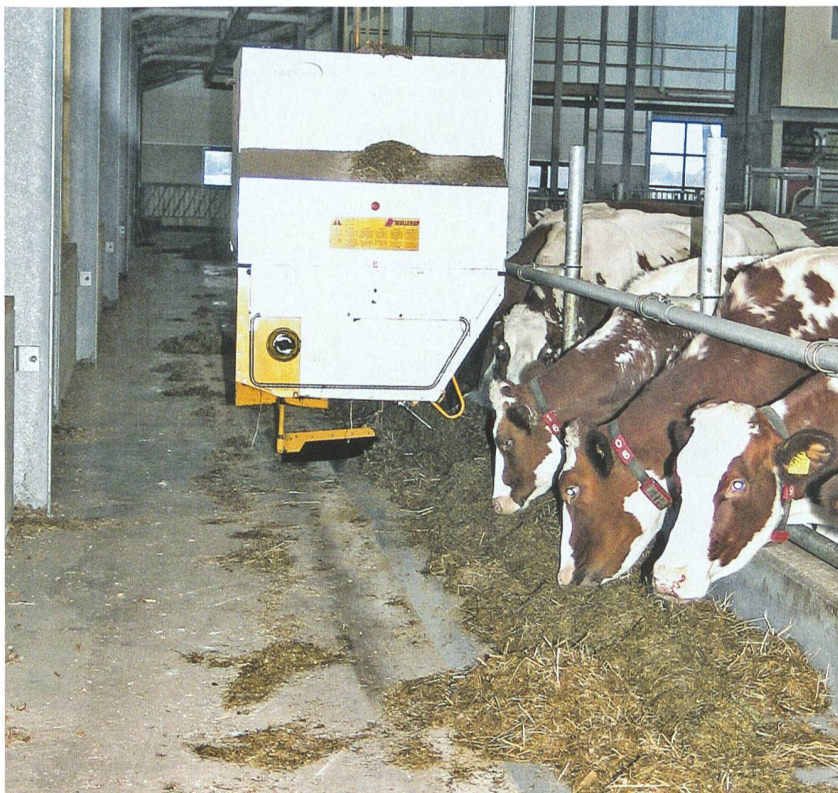
Abb. 1: Automatische Fütterungssysteme versorgen mehrere Tiergruppen rund um die Uhr mit frisch gemischtem Futter.
