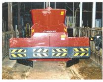
Abb. 8: Der schienengeführte Vertikalmischer (Triomatic) verfügt über zwei Mischschnecken und 3 Kubikmeter Fassungsvermögen. Aufgrund seiner Breite von 1,35 Meter und einer Länge von 3,13 Meter benötigt er eine genügende Futtertischbreite.
