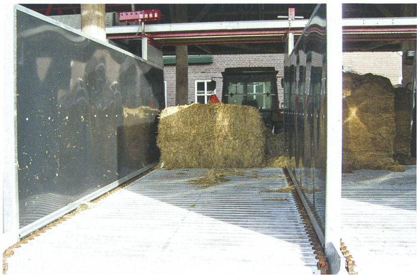
Abb. 11: Das Dosiersystem von Triomatic besteht aus einem Schneidrahmen (links) einem Wiege- und Förderband und mehreren Vorrats- und Zuführtschen für die Futterkomponenten (rechts). Der Schneidrahmen kann Siloblöcke und Grossballen verarbeiten und dabei das Futter auf die gewünschte Länge schneiden.
