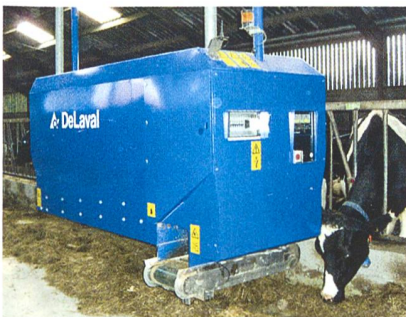
Abb. 5: Der schienengeführte Futterwagen (DeLaval) übernimmt das gemischte Futter vom stationären Mischer. Er kann beidseitig ausdosieren. Der Fütterungsrechner lässt sich ans System Alpro anbinden.
