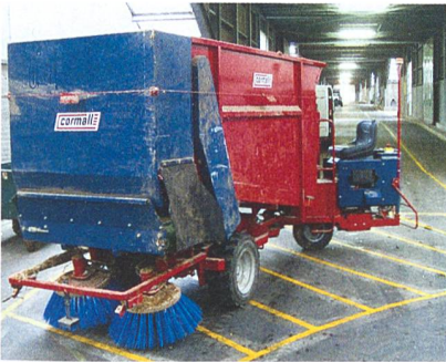
Abb. 4: Der automatische Futterwagen (Cormall) lädt die Ration beim stationären Mischer und fährt anschliessend selbstständig zur Futtervorlage. Der Antrieb erfolgt mit einem Dieselmotor. Mit den Radialbürsten kann er das Futter jederzeit wieder nachschieben.
