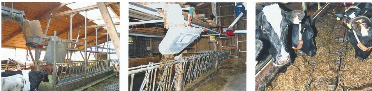
Abb. 3: Futterbänder legen einzelne Futterkomponenten oder Mischungen vor. Sie sind entweder über Kopfhöhe (links und Mitte) oder in der Krippe (rechts) angebracht. Sie sind entweder bei Neuerstellung direkt einbau- (links und Mitte) oder nachrüstbar.
