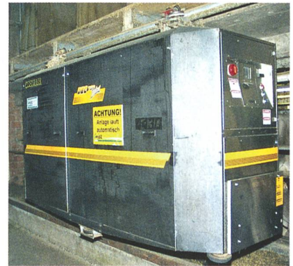
Abb. 7: Im DEC TMR plus (Rovibec) mischen zwei Mischpaddel das Futter während der Beschickung. Erhältlich sind acht Grössen mit Fassungsvermögen von 1,75 bis 8,06 Kubikmeter.
