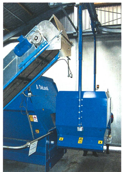
Abb. 9: Ein stationäre Mischer (DeLaval) erstellt die Mischration. Anschliessend beschickt die Beschickanlage den Futterverteilwagen. Sensoren überwachen die korrekte Dosierung.
