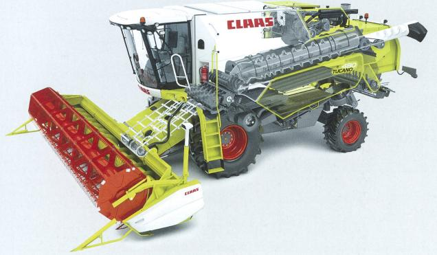
Schnittbild Claas TUCANO: APS + ROTO PLUS = HYBRID SYSTEM lautet die Formel bei Claas. Die beiden TUCANO-Topmodelle 470 und 480 arbeiten mit einem 4,20 m langen Einzelrotor. (Bilder: zVg)
