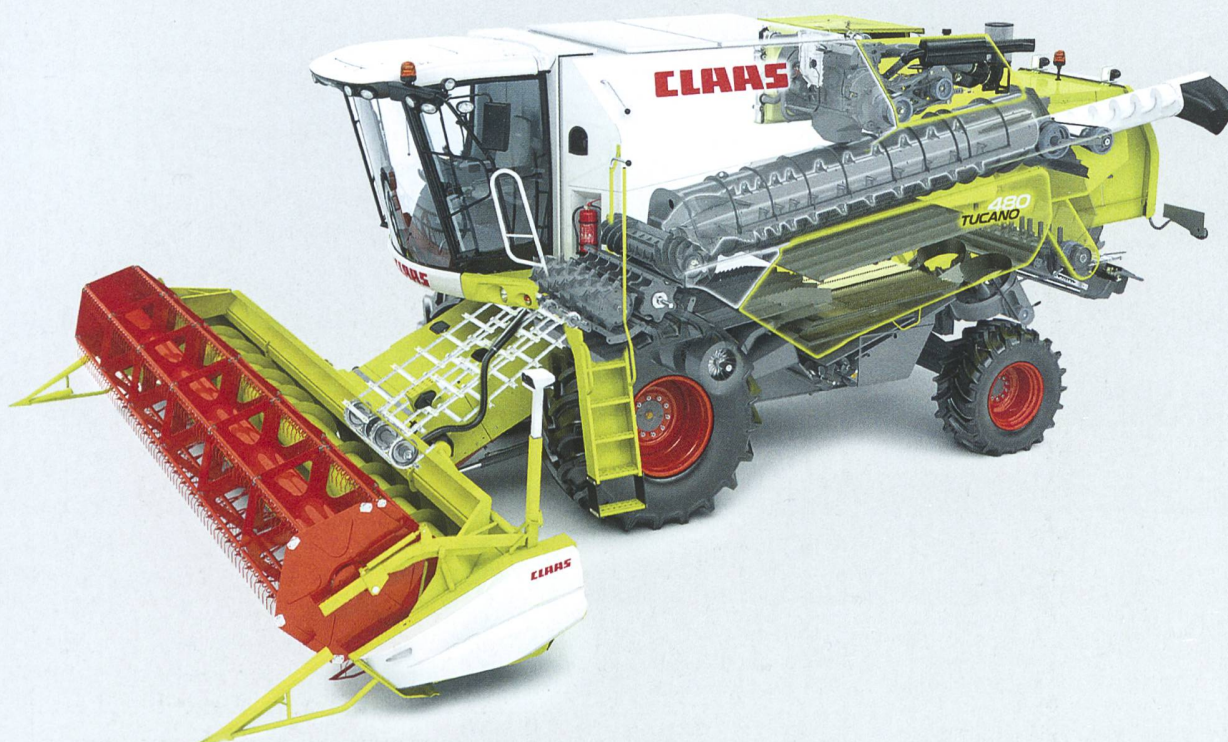
Schnittbild Claas TUCANO: APS + ROTO PLUS = HYBRID SYSTEM lautet die Formel bei Claas. Die beiden TUCANO-Topmodelle 470 und 480 arbeiten mit einem 4,20 m langen Einzelrotor. (Bilder: zVg)
