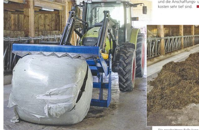
Mit dem Ballenschneider wird die Balle halbiert.
