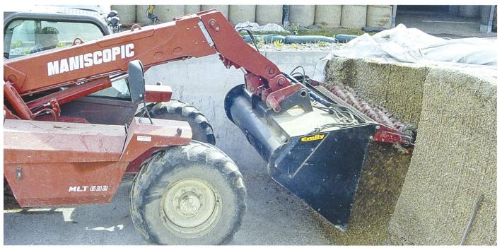
Siloverteilschaufel für die Entnahme und Vorlage von Maissilage. (Bild: Konrad Merk)
