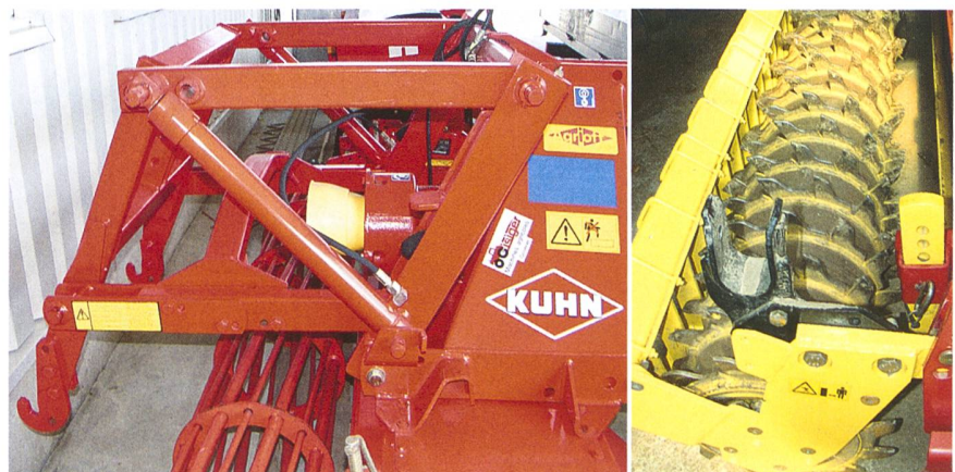
Kombinierte oder integral aufgesattelte Maschine. (Bilder: Gaël Monnerat)
