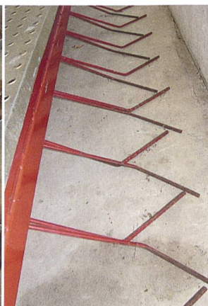
Viele Striegeltypen sind verfügbar, um die sichere Abdeckung des Saatgutes sicherzustellen. (Bilder: Gaël Monnerat)
