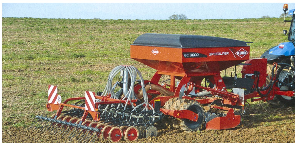
Konservierende Sätechnik ist eine Zwischenlösung zwischen Säen nach der Grundbodenbearbeitung und Direktsaat. (Werksfoto)
