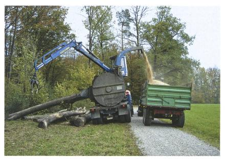
Abb. 6: Ein Grosshacker mit Kran erleichtert nicht nur die Arbeit, im überbetrieblichen Einsatz ist er auch kostengünstiger als die zapfwellenbetriebenen Anbau- oder Anhängehacker.
