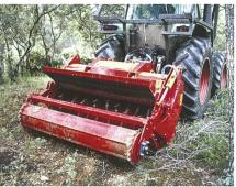
cherschlägeln und Gegenschneiden ist ein perfekter Schnitt und eine feinste Zerkleinerung des Mulchgutes gewährleistet.
