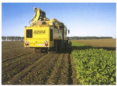
Der Luftdruck, die Radbelastung und die Zahl der Überfahren sind für die Gefahr der Bodenverdichtung bestimmend.
