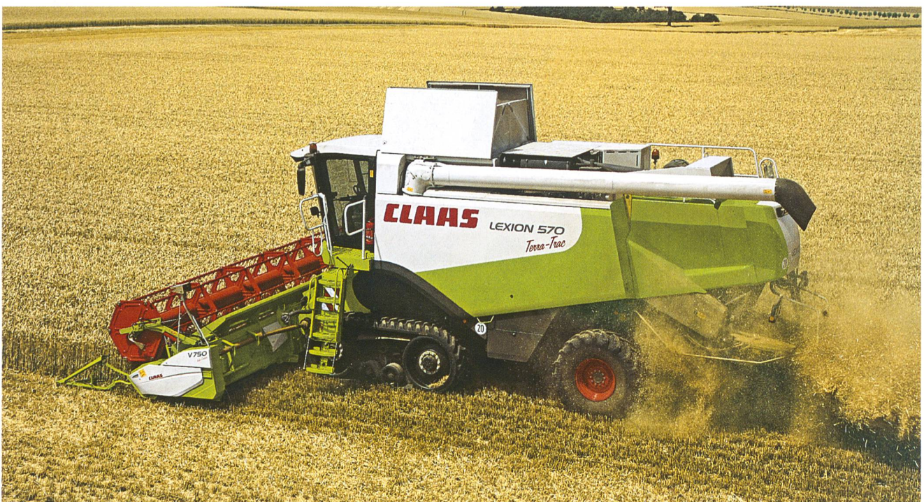
Weniger Bodenverdichtung durch die grosse Aufstandsfläche unter dem Gleisband. (Bild: zVg)
