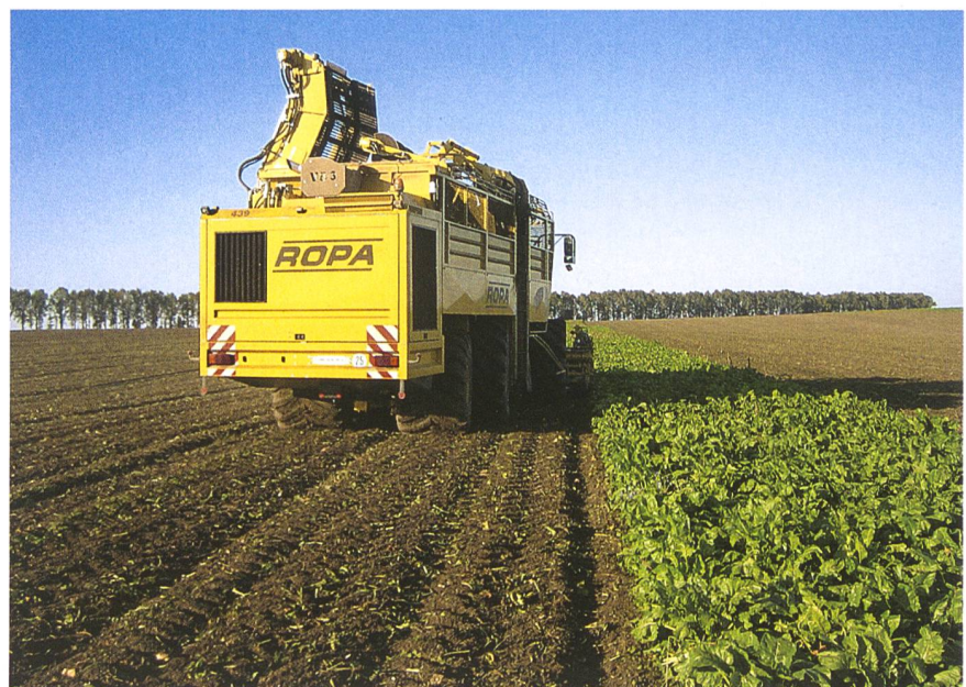
Der Luftdruck, die Radbelastung und die Zahl der Überfahren sind für die Gefahr der Bodenverdichtung bestimmend.
