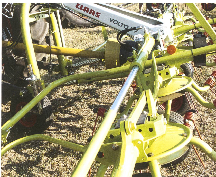
Kreiselzettwender mit kleinem Kreisdurchmesser und fünf Zinkenarmen für eine optimale Futteraufnahme und ein gleichmässiges Streubild. Spezielle Kraftflusslenker stabilisieren die Maschine im Einsatz.
