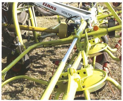
Kreiselzettwender mit kleinem Kreiseldurchmesser und fünf Zinkenarmen für eine optimale Futteraufnahme und ein gleichmässiges Streubild. Spezielle Kraftflusslenker stabilisieren die Maschine im Einsatz.
