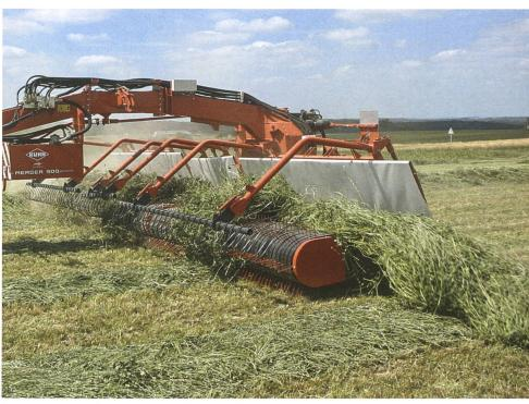
Schwader für die Querförderung auf drei Bandeinheiten. (Bild: zVg)
