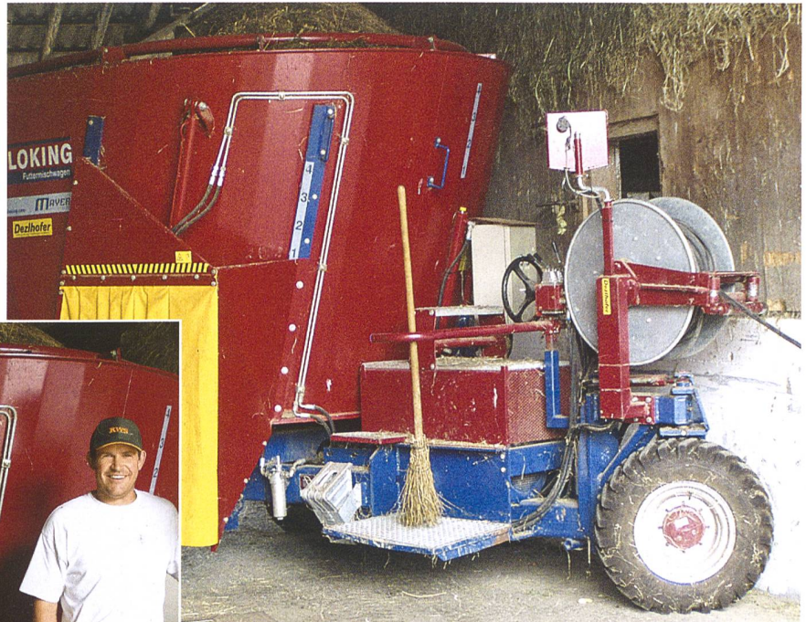
Ueli Günthardt (rechts) ist Präsident der SVLT-Sektion Graubünden. Er ist zusammen mit seinem Bruder Werner vom elektrischen Antriebskonzept für ihren Mischwagen überzeugt. So wird kein Traktor blockiert, argumentieren sie.
