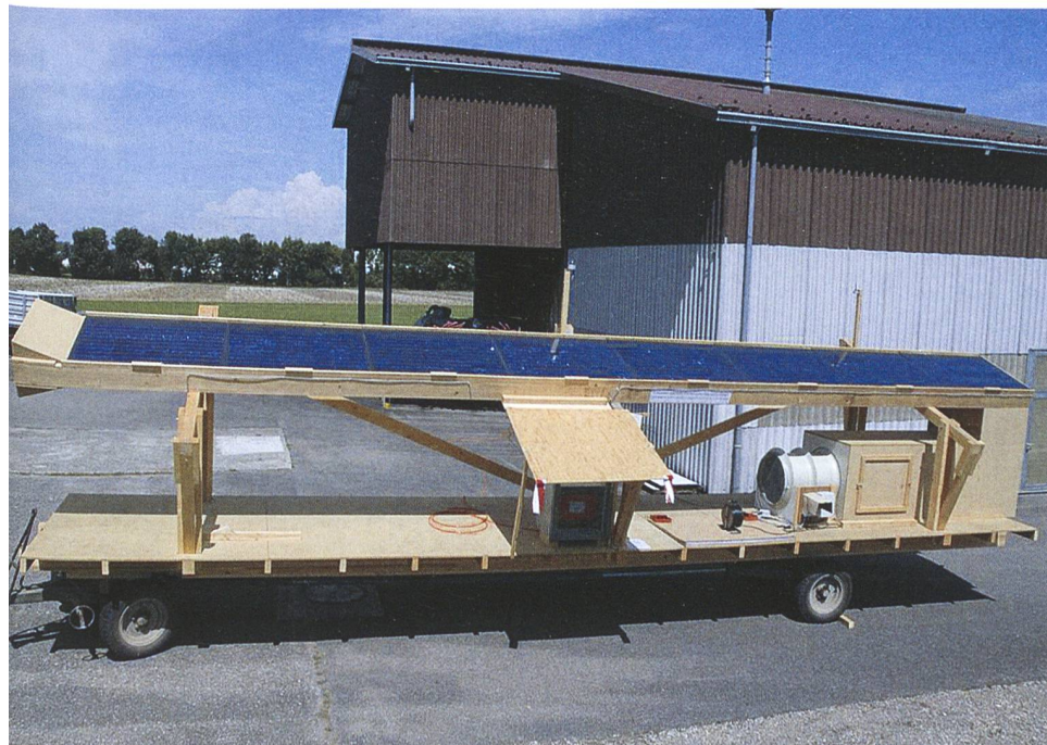
Versuchsanlage der ART mit acht im Dach integrierten Photovoltaikmodulen. (Bild: ART)
