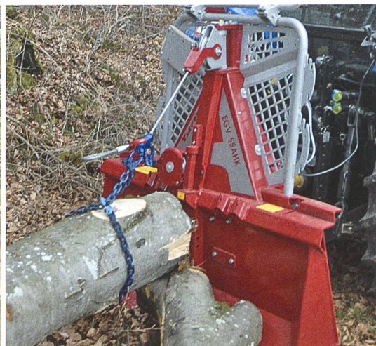
In den letzten Jahren wurden Seilwinden punkto Sicherheit und Ergonomie stark verbessert. Eine Funkbedienung erleichtert die Arbeit, stellt aber hohe Anforderungen an die Bedienungsperson.
