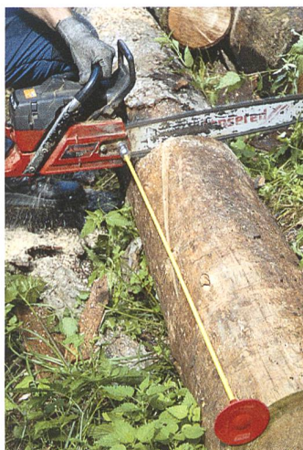
CUTCONTROL – ein relativ unbekanntes, aber sehr nützliches Hilfsmittel zum Ablängen des Holzes.
