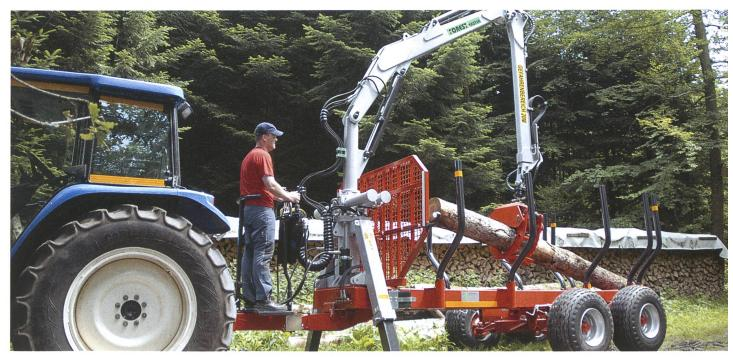
Rückekrananhänger: Im Schwenkbereich des Ladekrans darf sich niemand aufhalten. (Bilder: BUL)
