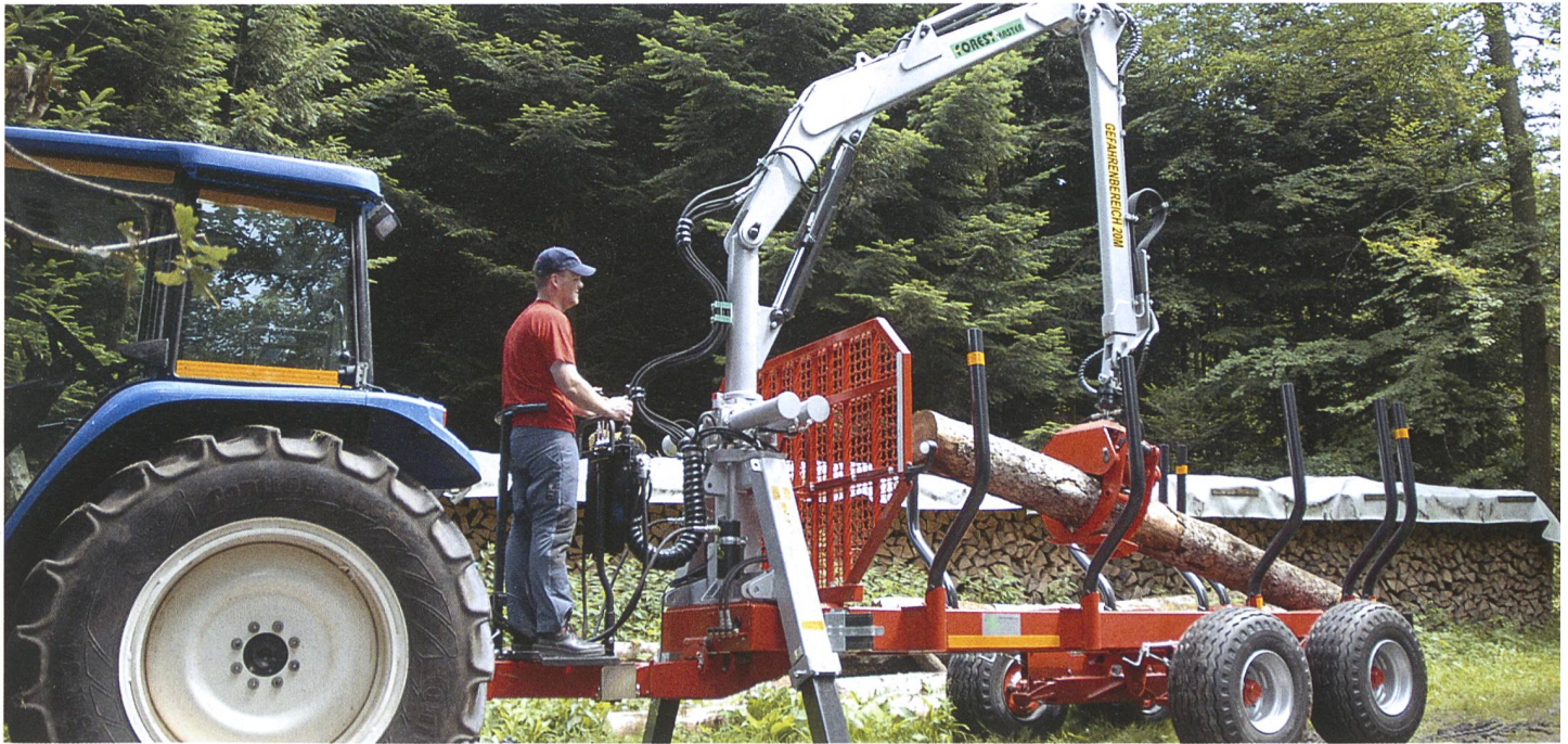
Rückekrananhänger: Im Schwenkbereich des Ladekrans darf sich niemand aufhalten. (Bilder: BUL)
