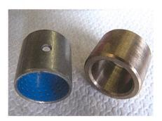
Die dünnwandige Lagerbuchse ist im Fachhandel leichter zu finden und wird entsprechend dem Herstellungsverfahren als «Gerollte Buchse» bezeichnet. Dickwandige Buchsen müssen in der Regel beim Maschinenvertreter bezogen werden.
