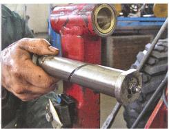
Damit sich das Schmierfett auf der ganzen Länge gut verteilen kann, müssen Gleitlager, die länger sind als ihr Durchmesser, entweder am Bolzen oder in der Lagerbuchse mit einer Schmiernut versehen sein
