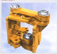
An Fahrzeugen mit Knicklenkung nach herkömmlicher Bauart ist das Gelenk starkem Verschleiss ausgesetzt. Dagegen zeigen Pendel-Knickgelenke, wie sie heute von den meisten Herstellern eingebaut werden, kaum Abnutzungserscheinungen und bieten zudem mehr Fahrkomfort und eine verbesserte Lenkbarkeit. Aus diesem Grund sollte man beim Kauf eines gebrauchten «Knicklenkers» nebst einem guten Zustand der Gelenke auch darauf achten, dass dieser mit einem Pendel-Knickgelenk ausgestattet ist.
