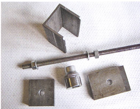
Als Ausbauvorrichtung für die Lagerbuchsen dienen eine Gewindestange der Grösse M12, zwei starke Stahlplatten und ein kurzes Stück U-Stahl oder Rohr.
