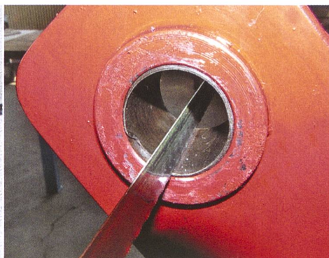
Gerollte Lagerbuchsen mit Stahlmantel können auch mal angerostet sein. Sie werden mit der Hand- oder Stichsäge an einer Seite durchgesägt und so im Lagersitz gelockert.
