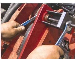
An Stelle des U-Profileisens kann bei Lagerbuchsen von grösserem Durchmesser ein Rohr besser geeignet sein.
