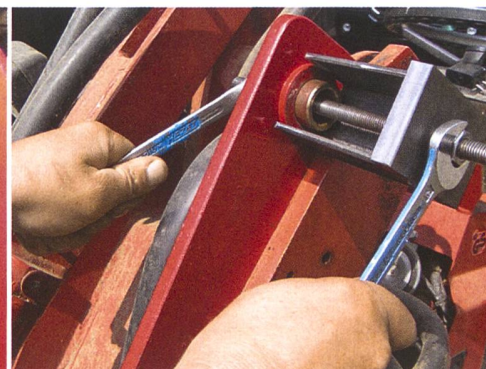
An Stelle des U-Profileisens kann bei Lagerbuchsen von grösserem Durchmesser ein Rohr besser geeignet sein.
