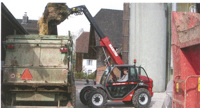
Dank der Hubhöhe von rund fünf Metern kann der Manitou MLT 523 den hohen Mistzettler problemlos und rationell beladen.
