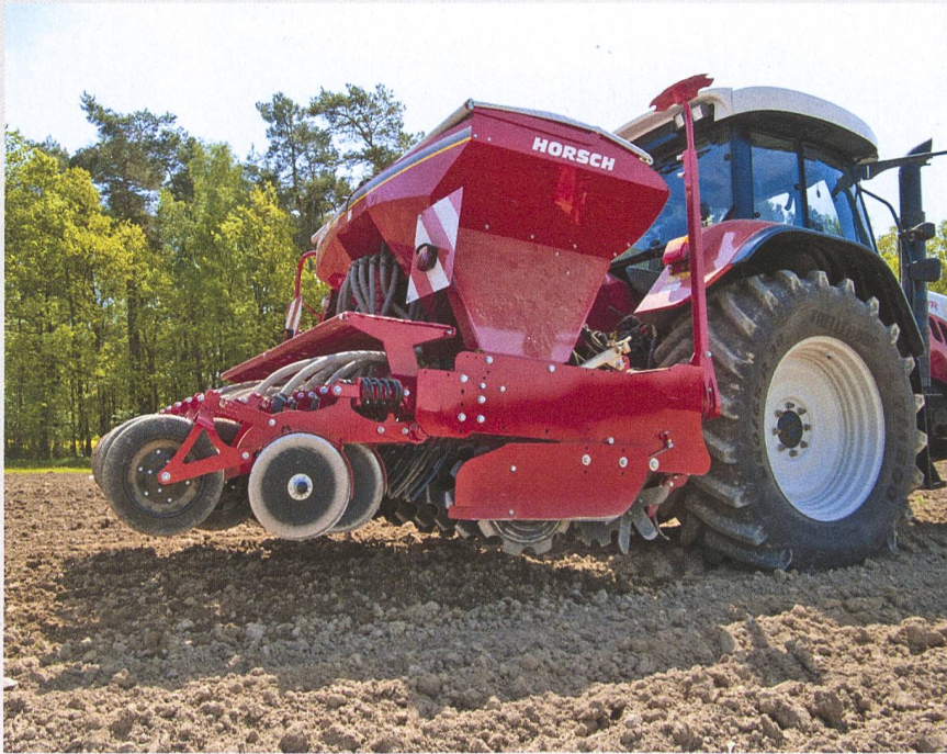
Pneumatische Säkombination Express 3HD. (Werkbild)
