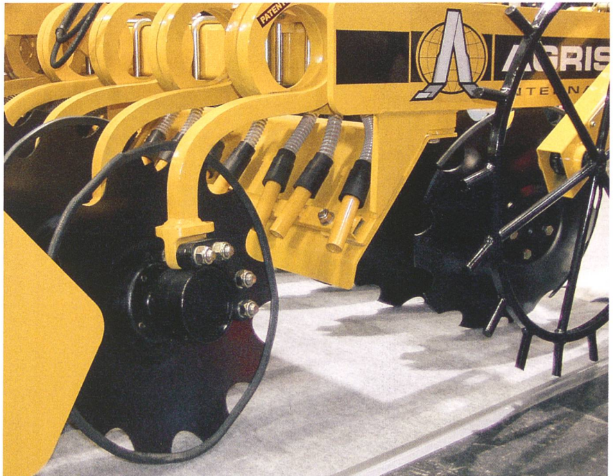
Kurzscheibeneggen konkurrieren seit einigen Jahren erfolgreich mit dem Grubber um die Vorherrschaft bei der Stoppelbearbeitung.
