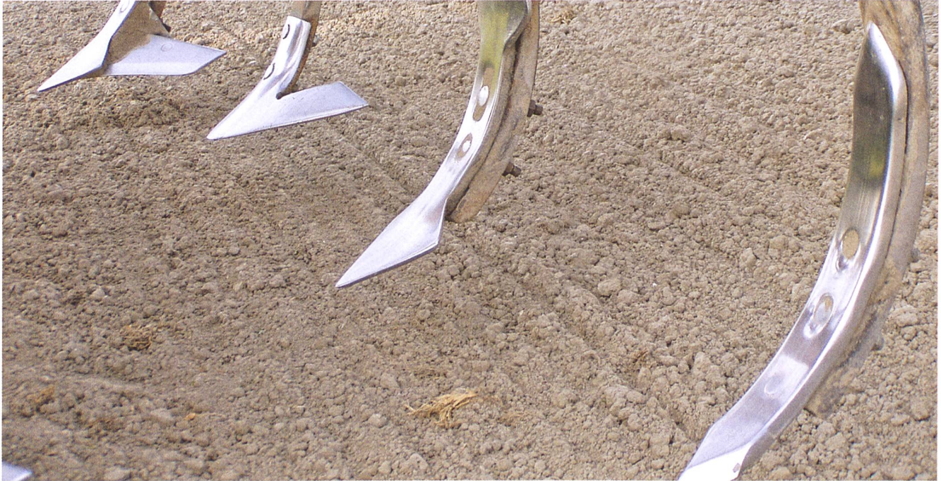
Von links nach rechts: Flügelschar, Gänsefusschar, Doppelherzschar und Spitzschar sind übliche Grubber-Werkzeuge mit unterschiedlicher Eignung für die Stoppelbearbeitung. (Bilder: Ruedi Hunger)
