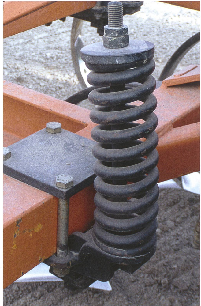
Überlastsicherung mittels Spiralfeder.
