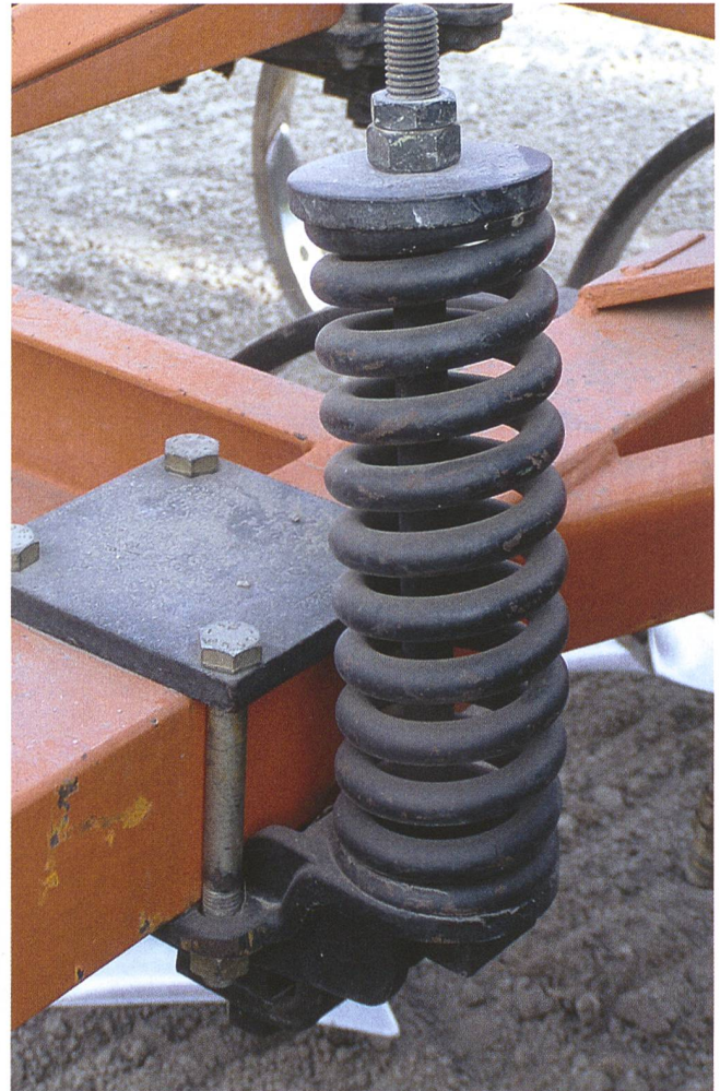
Überlastsicherung mittels Spiralfeder.
