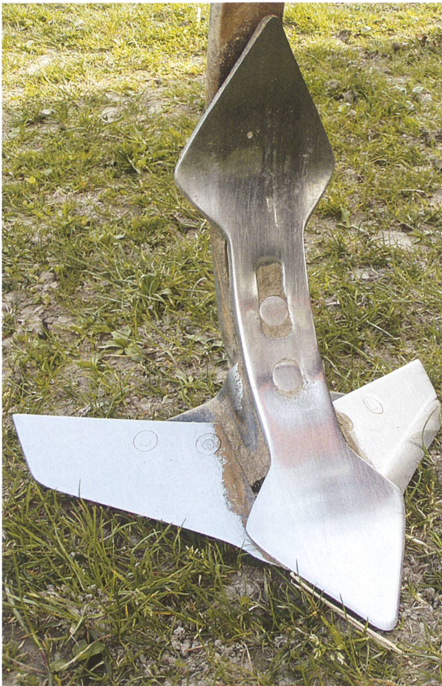
Die Flügelschar ist gut geeignet für eine flache Bodenbearbeitung.
