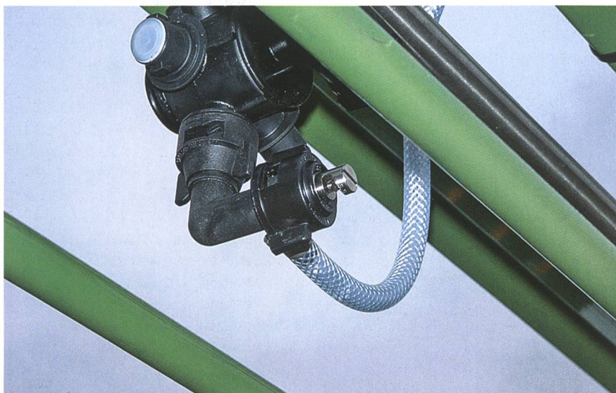
Zweistoffdüse John Deere (Twin Fluid). Die Spritzbrühe wird vor dem Austritt in einer Vorkammer mit Druckluft aufgemischt. (Werkfoto)
