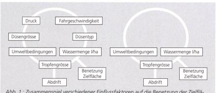
Abb. 1.: Zusammenspiel verschiedener Einflussfaktoren auf die Benetzung der Zielfläche und die Abdrift bei der herkömmlichen Spritzentechnik (links) und bei modernen Düsensystemen (z.B. Zweistoffdüsen oder Düsen mit Magnetventilen)
