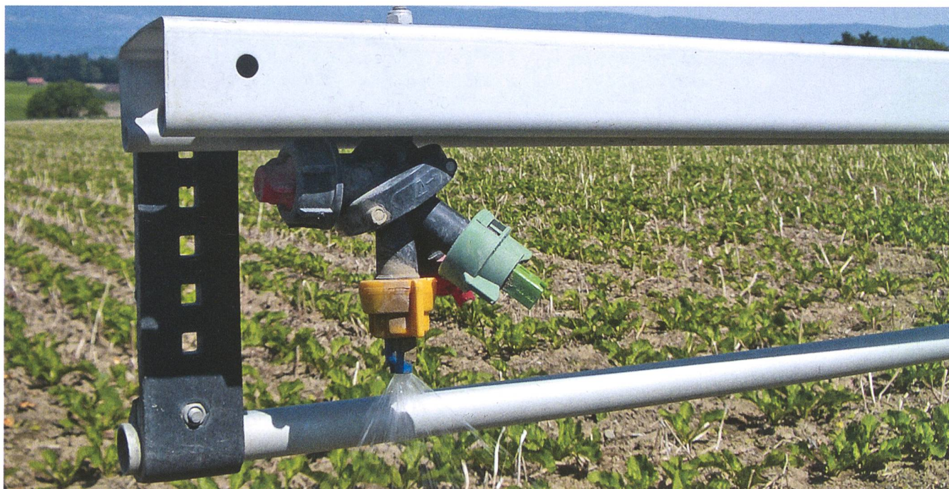
Das breite Einsatzspektrum eines Pflanzenschutzgerätes kann mit einer einzigen Düsenart schwerlich abgedeckt werden. In der Praxis haben sich deshalb Mehrfach-Düsenkörper bewährt. (Bilder: Bernhard Streit)
