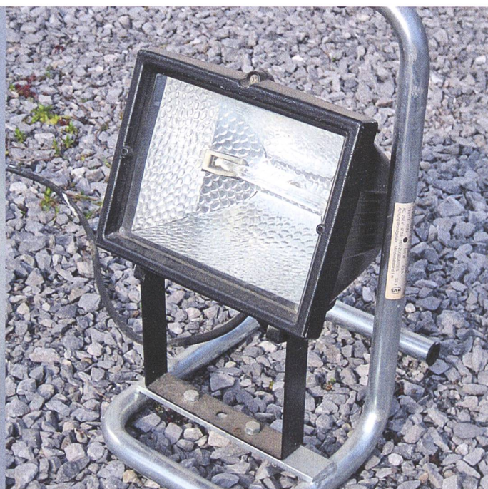
Halogenstrahler sind zwar billig in der Anschaffung, doch uneffiziente Stromfresser im Gebrauch. Weil sie sehr heiss werden, besteht Brandgefahr. Halogenstrahler sind deshalb in Scheunen nicht zugelassen.
