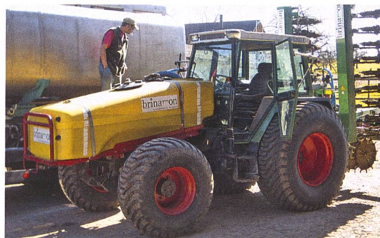
Vorratstank wird mit Flüssigdünger aus Tankwagen befüllt.
