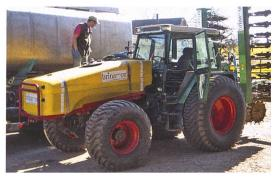
Vorratstank wird mit Flüssigdünger aus Tankwagen befüllt.
