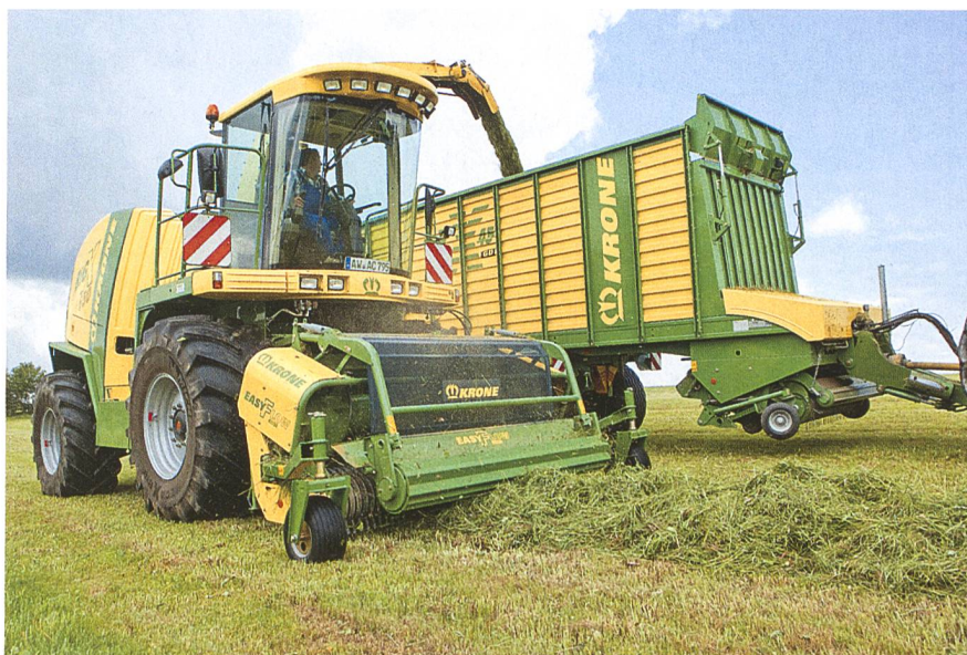
Krone setzt bei den Big X-Modellen auf sechs Vorpresswalzen. Die EasyFlow-Pickups arbeiten ohne Kurvenbahnsteuerung.
