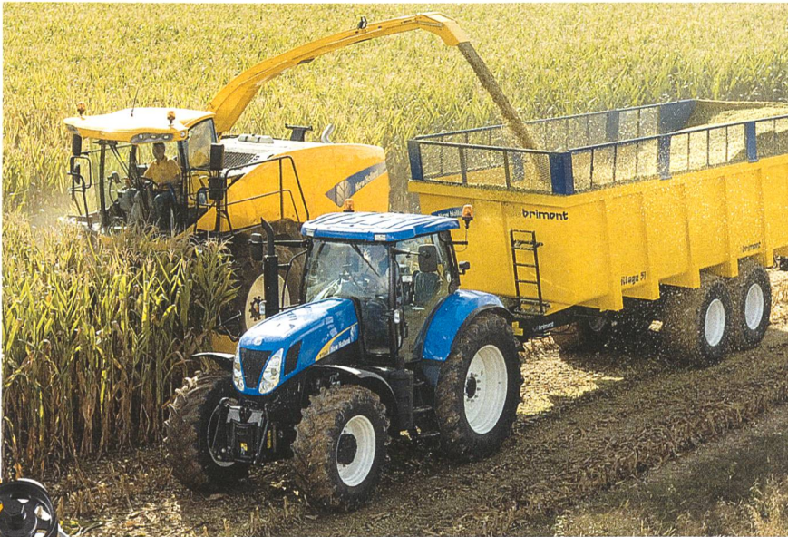
In der FR9000-Baureihe von New Holland kommt das neuartige Variflow-System zum Einsatz. Beim Wegschwenken des Körnerprozessors rückt das Wurfgebläse 60 cm näher zur Häckseltrommel.
