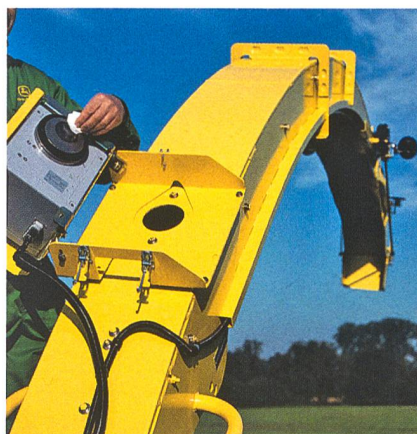
Bei den Maschinen von JD erfasst ein Infrarot-Sensor laufend die Erntegutfeuchte. Entsprechend wird die Schnittlänge über das stufenlose Verstellgetriebe angepasst.
