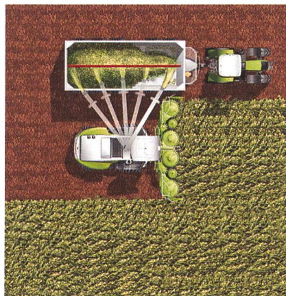
Der Krümmerpilot von Claas sorgt dafür, dass der Häckselgutstrahl beim Schwenken des Auswurfkrümmers immer automatisch parallel zur Fahrtrichtung geführt wird
