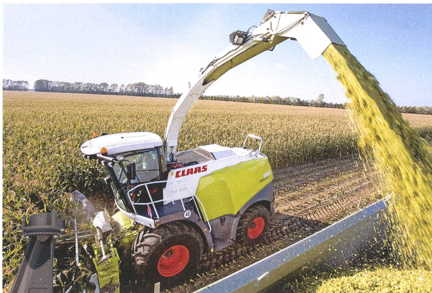
Bei der jüngsten Jaguar-Baureihe von Claas kommt die neue V-Max-Trommel in offener Bauweise zum Einsatz. Die V-förmig angeordneten Messer werden mit nur je zwei Schrauben befestigt.
