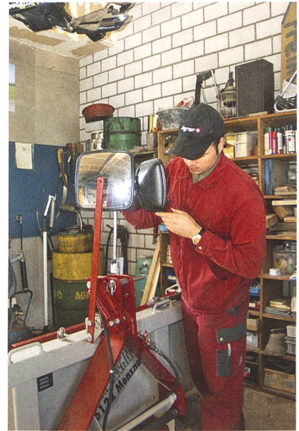
Sinn fürs Praktische: Hydraulischer Auslösemechanismus an der Heck- bzw. Frontschaukel.
