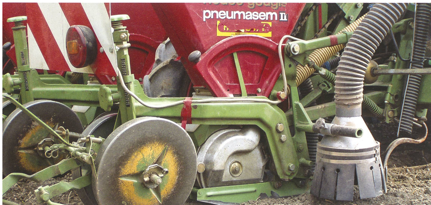
Deflektor-Nachrüstung für die Abluftführung bis in Bodennähe. Damit lässt sich die Gefahr von Beizmittelstaub in der Luft wirksam reduzieren. (Bild: Ruedi Hunger)
