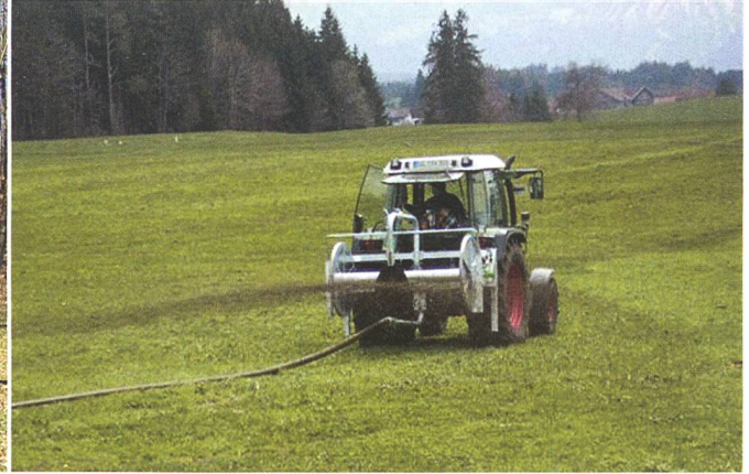
Automatisierte Gülleverteilsysteme mit Wurfdüse (Fankhauser AG) oder mit Prallteller (Hochdorfer Technik AG) erzielen eine relativ konstante Ausbringungsmenge.
