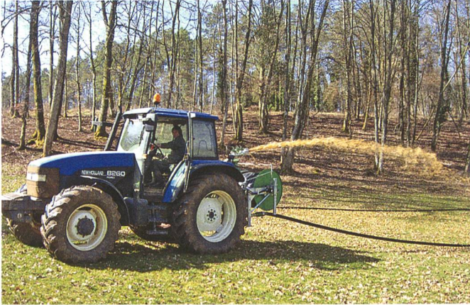
Automatisierte Gülleverteilsysteme mit Wurfdüse (Fankhauser AG) oder mit Prallteller (Hochdorfer Technik AG) erzielen eine relativ konstante Ausbringungsmenge.
