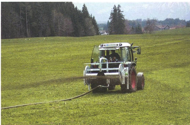
Automatisierte Gülleverteilsysteme mit Wurfdüse (Fankhauser AG) oder mit Prallteller (Hochdorfer Technik AG) erzielen eine relativ konstante Ausbringmenge.
