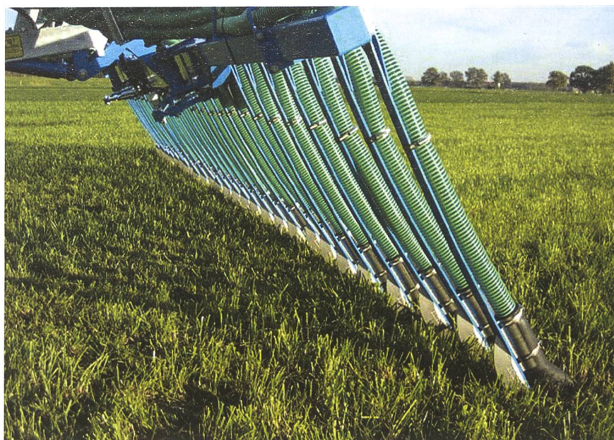
Schleppschuhverteiler Bomech: Mit einem Federstahl werden die Schuhe in den Boden gedrückt.
