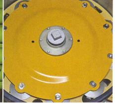
Unterschiedlich konstruierte Verteilköpfe für Schleppschlauchverteiler und ihr gemeinsames Ziel: keine Verstopfungen auch bei strohreicher Gülle und präzise Dosierung auf die Abgangsschläuche.
