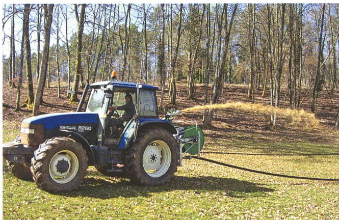
Automatisierte Gülleverteilsysteme mit Wurfdüse (Fankhauser AG) oder mit Prallteller (Hochdorfer Technik AG) erzielen eine relativ konstante Ausbringmenge.
