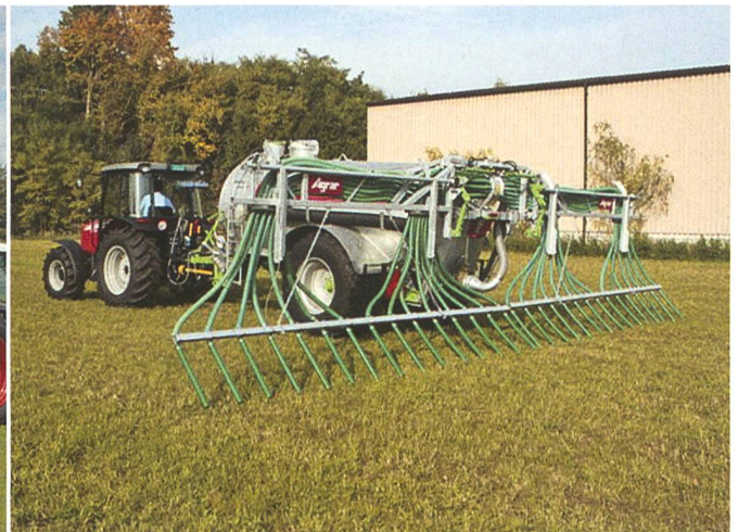
Viele Kantone fördern die Gülleausbringung mittels Schleppschlauchverteiler: links Joskin-Fass, rechts Agrarfass mit Vogelsang-Verteiler.
