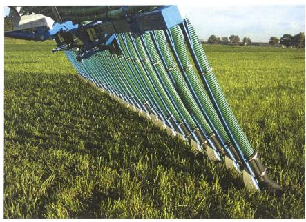
Schleppschuhverteiler Bomech: Mit einem Federstahl werden die Schuhe in den Boden gedrückt.
