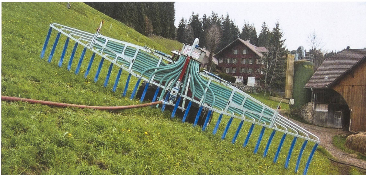
Schleppschlauchverteiler Wälchli: Wenn beim Verteilkopf ein Druck von 0,5–1,0 bar vorhanden ist, kann auch in Hanglagen mit einer gleichmässigen Verteilung der Gülle gerechnet werden. (Bilder: zVg)
