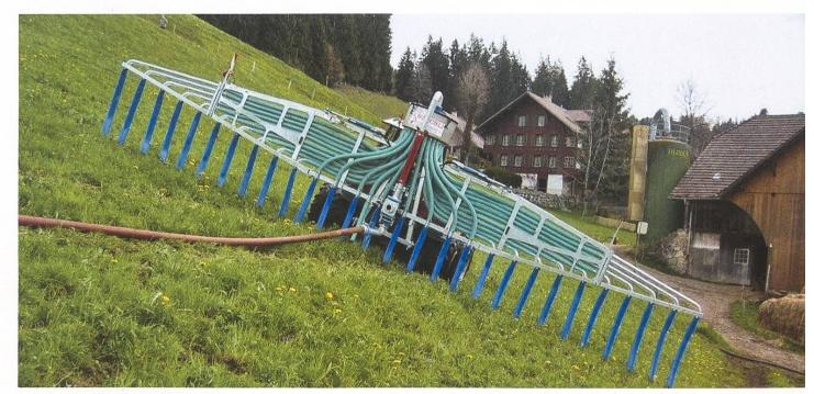
Schleppschlauchverteiler Wälchli: Wenn beim Verteilkopf ein Druck von 0,5–1,0 bar vorhanden ist, kann auch in Hanglagen mit einer gleichmässigen Verteilung der Gülle gerechnet werden. (Bilder: zVg)
