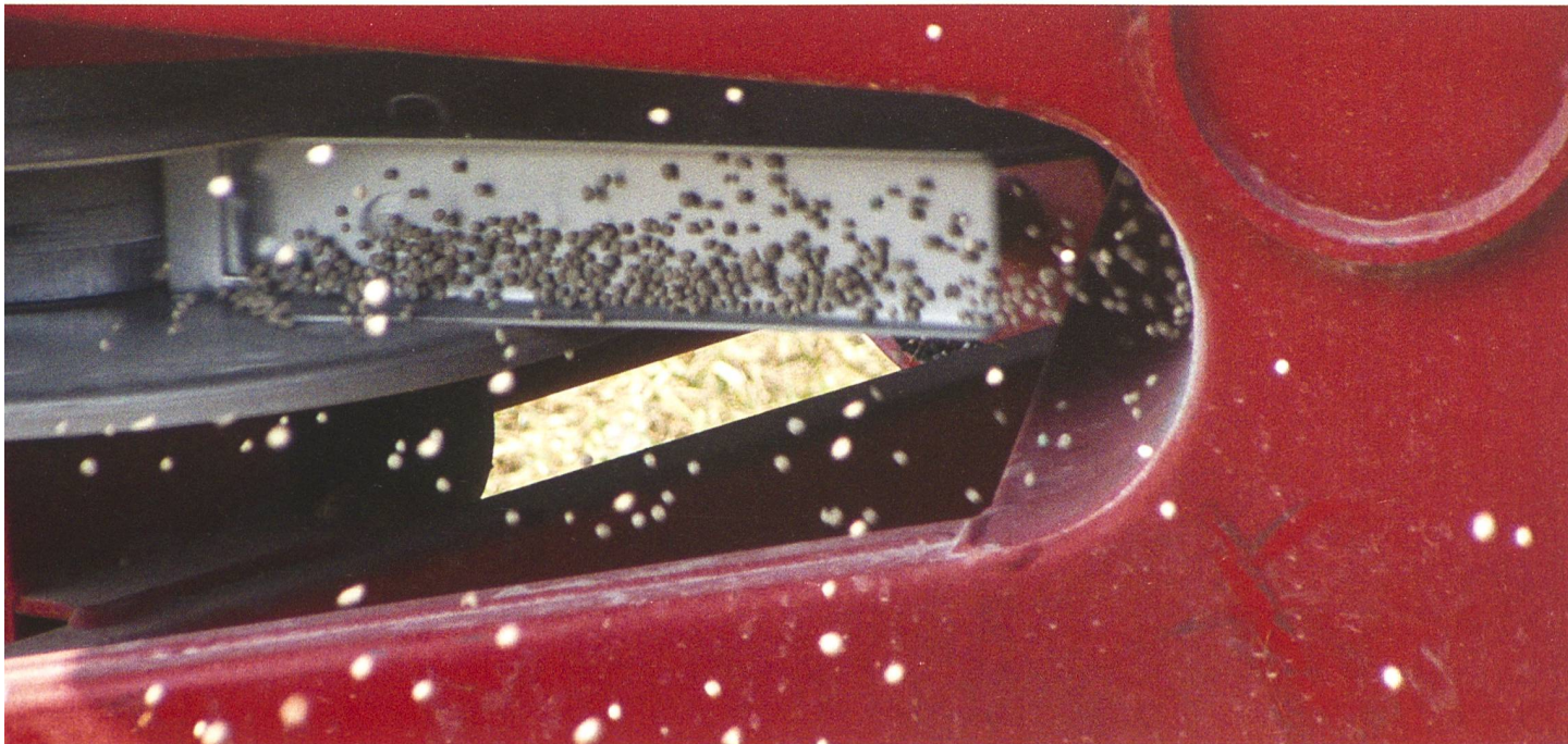
«Das Flugverhalten des Düngerkorns wird durch seine Form, seine Dichte und die Beschleunigung bestimmt.» (Bilder: Ruedi Hunger)
