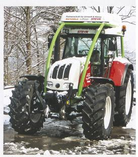
Biogastraktor mit Composit-Flaschen auf dem Dach als Prototyp für den sauberen Betrieb des Dieselmotors mit Erd- und Biogas.
