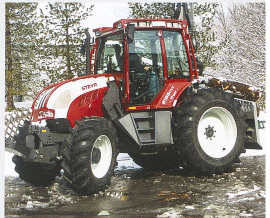
Zusammen mit der Firma Pfanzelt Maschinbau entwickelte Steyr den neuen CVT-Trac für den Kommunal- und Forstein-satz. Am Heck ist das Fahrzeug mit einer Wechselkonsole für schwere Arbeitsgeräte ausgestattet.
