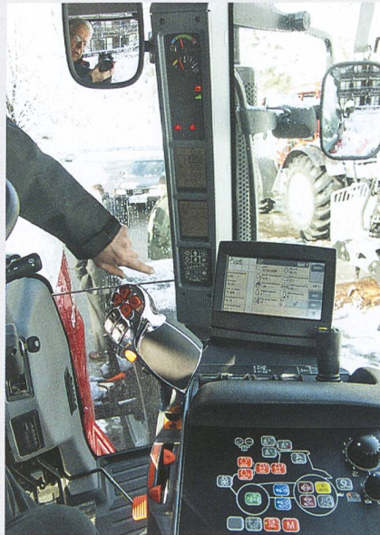
Multicontroller, AFS-Monitor und ICP-Beidienpanel sowie Steuerventile, alles auf der Konsole der rechten Armlehne vereint.
