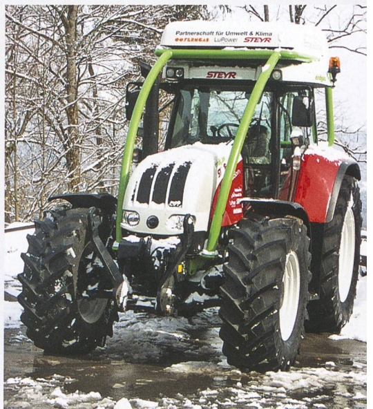
Biogastraktor mit Composit-Flaschen auf dem Dach als Prototyp für den sauberen Betrieb des Dieselmotors mit Erd- und Biogas.
