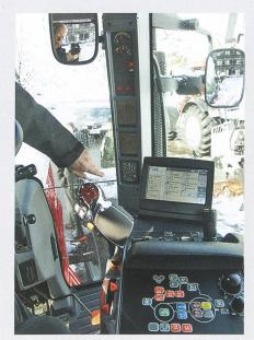
Multicontroller, AFS-Monitor und ICP-Bedienpanel sowie Steuerventile, alles auf der Konsole der rechten Armlehne vereint.
