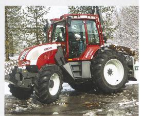
Zusammen mit der Firma Pfanzelt Maschinenbau entwickelte Steyr den neuen CVT-Trac für den Kommunal- und Forsteinsatz. Am Heck ist das Fahrzeug mit einer Wechselkonsole für schwere Arbeitsgeräte ausgestattet.
