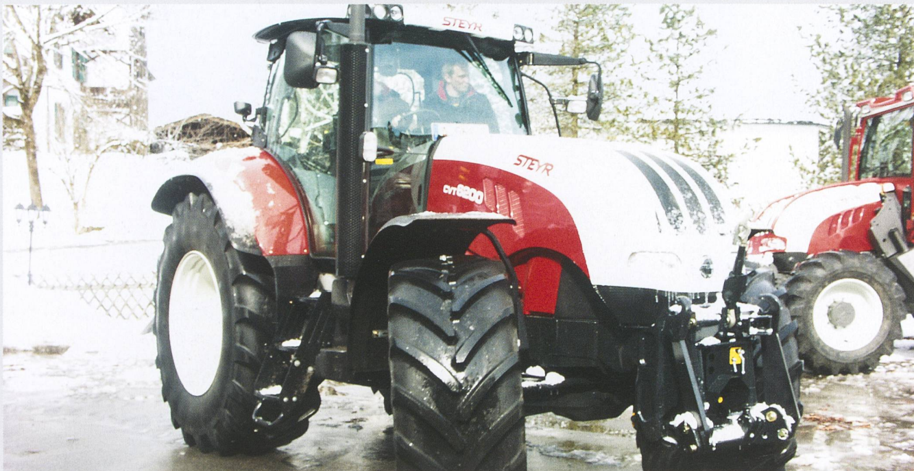
Geballte Kraft des neuen Steyr CVT 6200; Erfassung der Fahrbedingungen durch einen Beschleunigungssensor. Dieser beeinflusst die Dämpfung der Vorderachsfederung. (Bilder: Ueli Zweifel)
