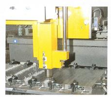
Bedeutsamer Entwicklungsschritt: Rührreibschweisstechnik zur perfekten Verbindung von Alu-Profilen für Kühler in Lokomotiven und Alternativenergieanlagen.
