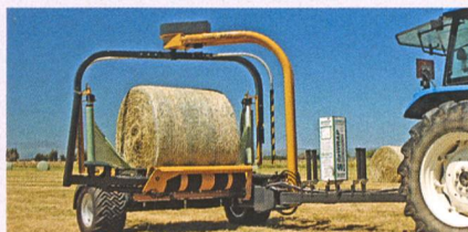
Tanco Autowrap 1400 EH soll bis zur 90 Ballen pro Stunde wickeln.
