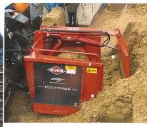
Entnahme- und Verteilgerät mit Entnahmeschild. Der Kraftbedarf für die Hydraulik ist erheblich.
