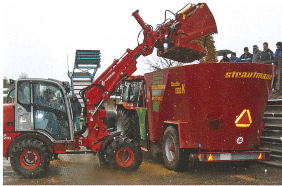
Schneidezange für Frontlader und Ausleger lässt sich vielseitig einsetzen und rationalisiert die Beschickung von Futtertisch und Mischwagen.
