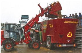
Schneidezange für Frontlader und Ausleger lässt sich vielseitig einsetzen und rationalisiert die Beschickung von Futtertisch und Mischwagen.
