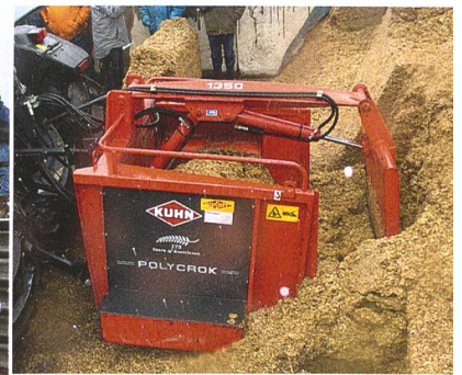
Entnahme- und Verteilgerät mit Entnahmeschild. Der Kraftbedarf für die Hydraulik ist erheblich.
