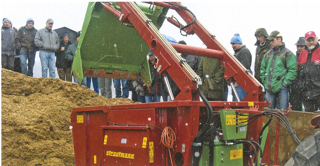
Die Maschinenvorführung zum innerbetrieblichen Handling von Silage stiess auf ein grosses Interesse. Im Einsatz ein Entnahme- und Verteilgerät mit Schneidschild. (Bilder: Astrid Böll, Fachstelle für Landtechnik, LBBZ Liebegg)
