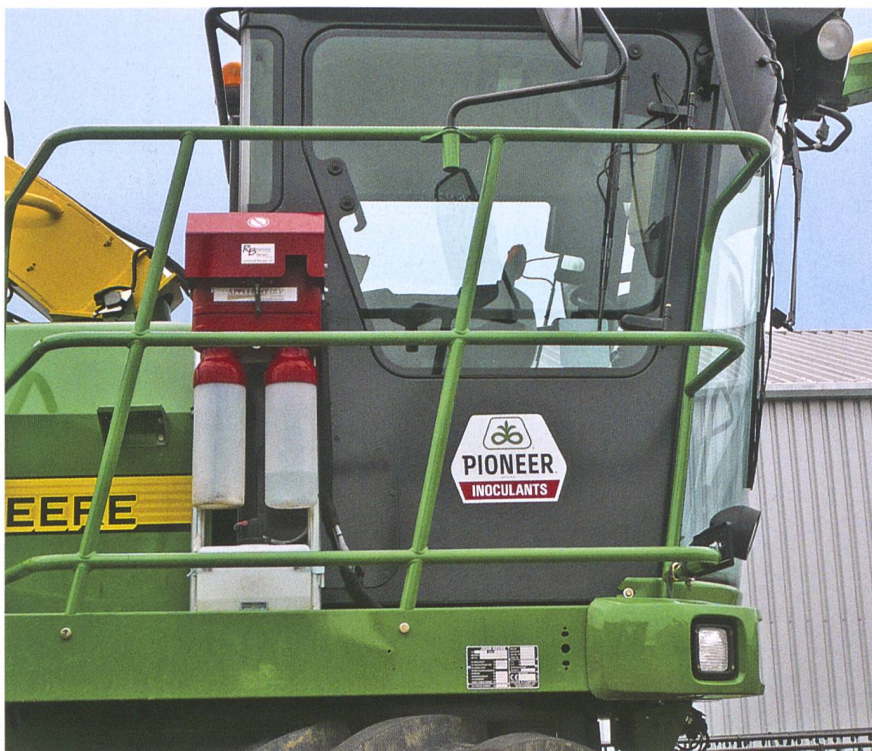
Siliermittelapplikation: Die Technik mit Ultra-Low Volume-Dosierung kann nur beim Häcksler eingesetzt werden. (Bild: Gerhard Ziehli, Matra)
