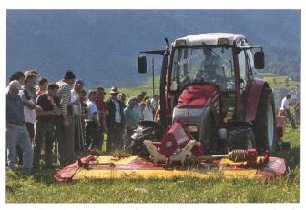
Frontmähwerke benötigen einen Anbaubock mit einer ausgeklügelten Kinematik.
