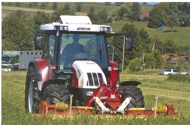
Luzernebestände reagieren unter Umständen empfindlich auf die Futterkonditionierung. Walzenaufbereiter ist der Vorzug zu geben.
