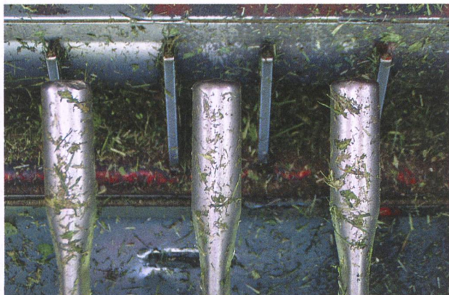
Beweglich montierte Werkzeuge für die Aufbereitung brauchen eine höhere Leistung als fest montierte.
