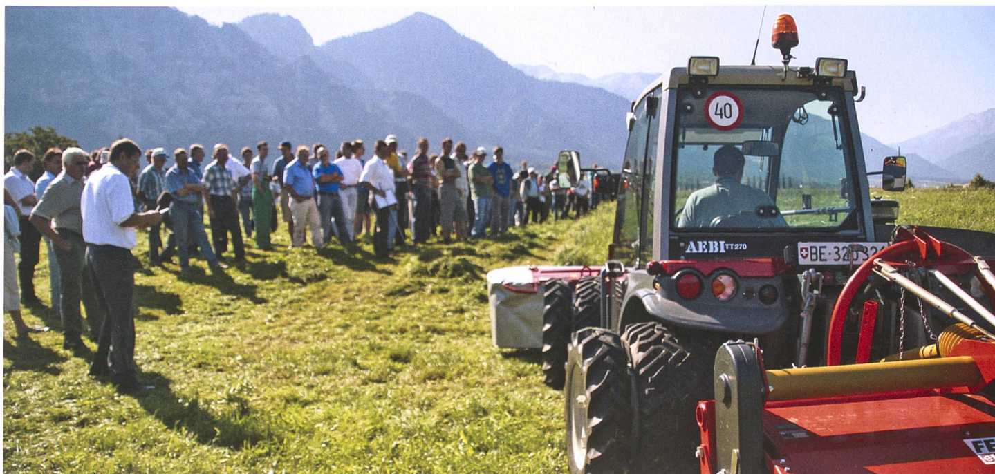
Starke Zweiachsmäher schaffen die Voraussetzung, um die Vorteile des Aufbereiteters auch im Bergbetrieb zu nutzen. (Bilder: Patricia Wolf, Ruedi Hunger, Plantahof)
