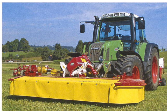
Mähwerk vorne und Aufbereiter hinten: ideal für eine gute Gewichtsverteilung.
