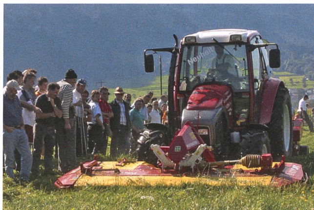
Frontmähwerke benötigen einen Anbaubock mit einer ausgeklügelten Kinematik.
