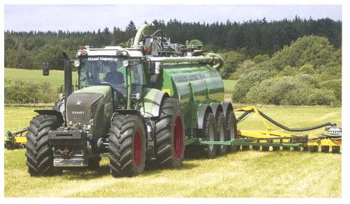
Gülle eindrillen nach dem Muster des Controlled Traffic Farming in Dänemark. Der Schlepper bewegt sich durch DGPS-Steuerung und Autopilot immer in den gleichen Fahrspuren. (Bild: Ueli Zweifel)
