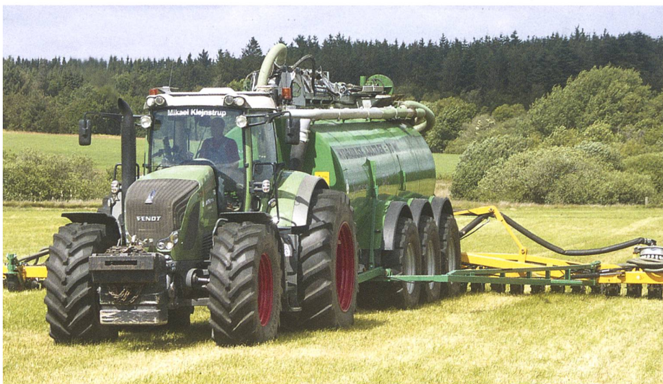
Gülle eindringen nach dem Muster des Controlled Traffic Farming in Dänemark. Der Schlepper bewegt sich durch DGPS-Steuerung und Autopilot immer in den gleichen Fahrspuren. (Bild: Ueli Zweifel)
