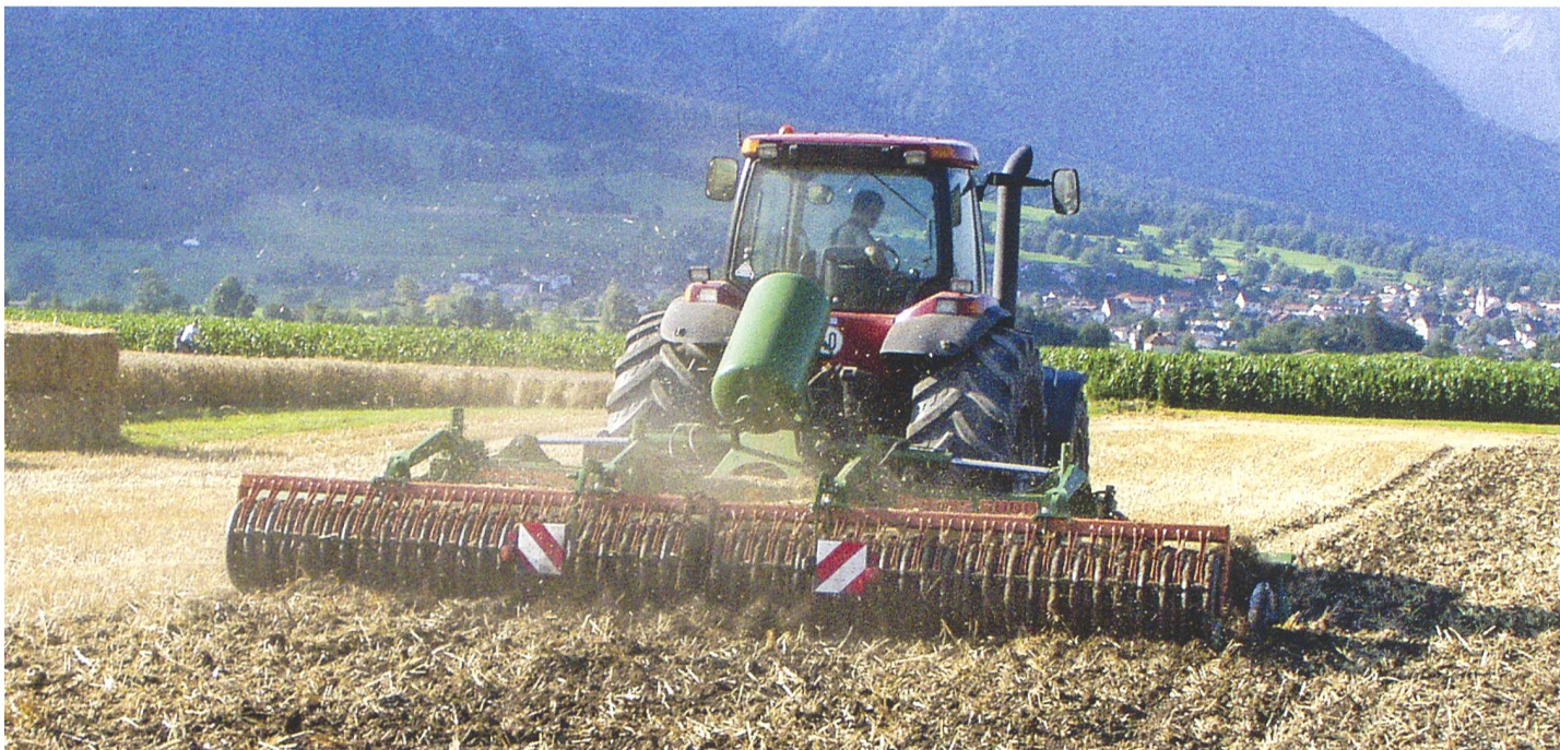
Flache und schlagkräftige Stoppelbearbeitung zählt zu den Spezialitäten der Kurzscheibeneggen. (Bilder: Ruedi Hunger)
