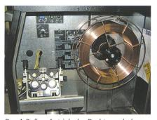
Der 4-Rollen-Antrieb des Drahtvorschubgerätes sichert beim Schutzgasschweissgerät den zuverlässigen Vorschub des Drahtes.
