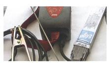
Elektrodenhalter und Werkstückklemme sollen für den rauen Einsatz eher etwas überdimensioniert sein. Mit basisch umhüllten Elektroden in den Durchmessern 2,5 mm und 3,2 mm können die meisten Schweissarbeiten erledigt werden.
