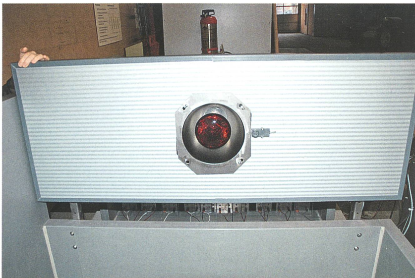
Abb. 2: Geöffnetes Isonest-IR. Rechts neben der IR-Lampe (150 W) ist der IR-Sensor ersichtl.
