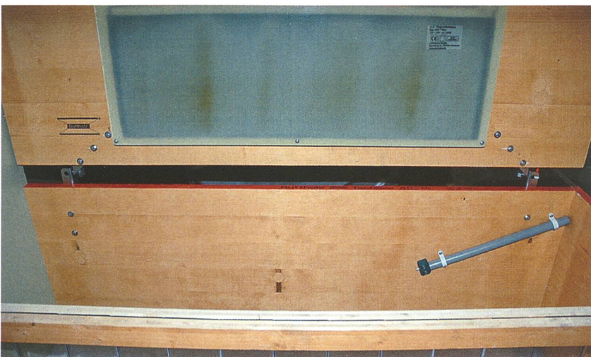
Abb. 4: Geöffnetes konventionelles Nest (Heizplatte 290 W). Die Umwandlung besteht aus Betonschalttafeln.
