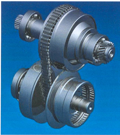
Beim Kompakttraktor Boomer 3045 von New Holland kommt erstmalig in der Landtechnik ein Kettenvariator zum Einsatz. Der SIMA-Jury war dies eine Silber-Medaille wert.
