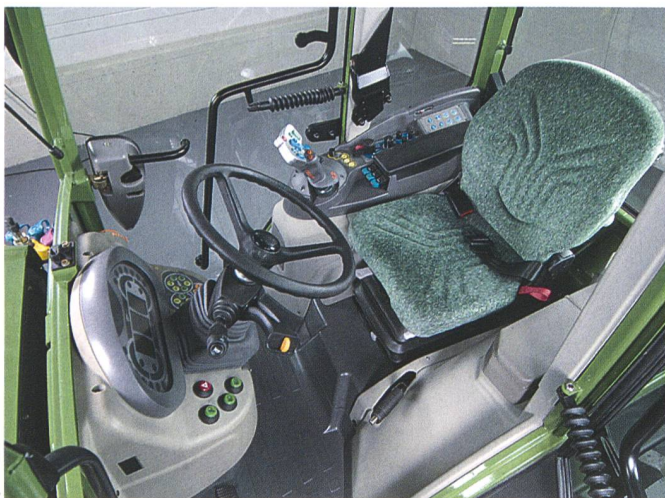
Kleiner Fendt nun auch stufenlos: Die kompakte Bauweise des neuen Vario-Getriebes ermöglicht auch bei den Schmalspurtraktoren einen ebenen Kabinenboden. Fendt wurde für diese Konzeption mit einer SIMA-Silber-Medaille ausgezeichnet.
