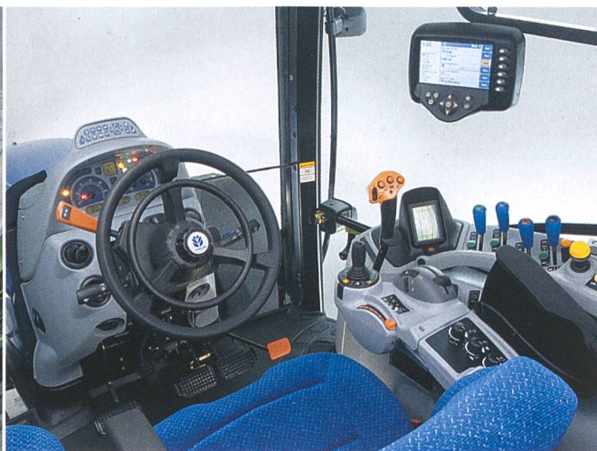
Schnell von einem Lenkansschlag zum anderen: Beim FastSteer-System von New Holland ist dies durch Drücken des Ringes im Lenkrad mit einer halben Lenkradumdrehung möglich.
