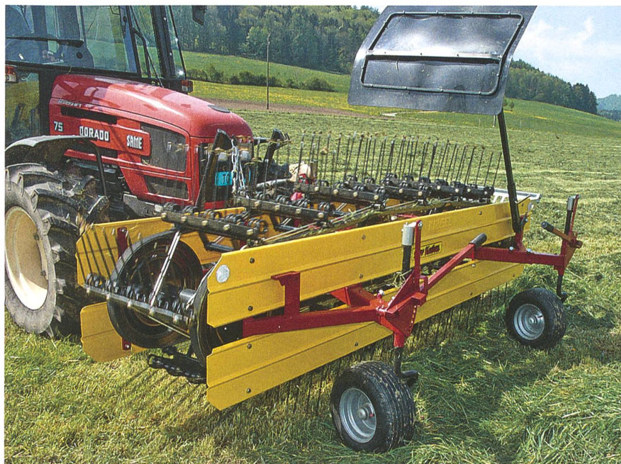
Der Bandrechen zeigt seine Vorteile im Berggebiet und auf unebenen Flächen.
