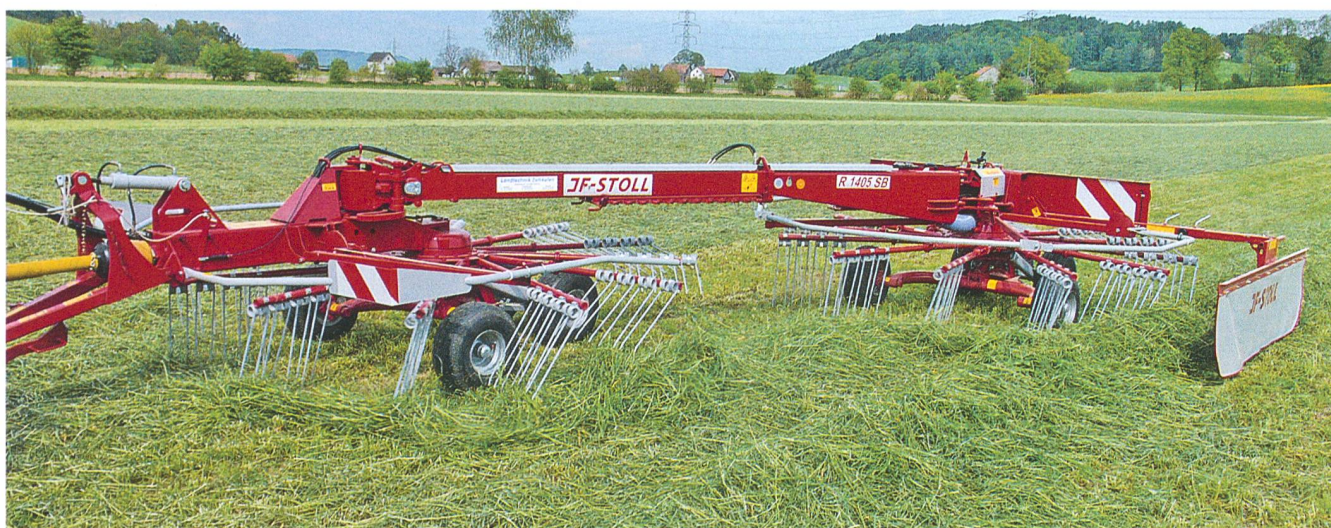
Der Seitenschwader ist ideal für kleinere Traktoren geeignet. Er zeigt seine Vorteile insbesondere bei geringen Aufwuchsmassen.
