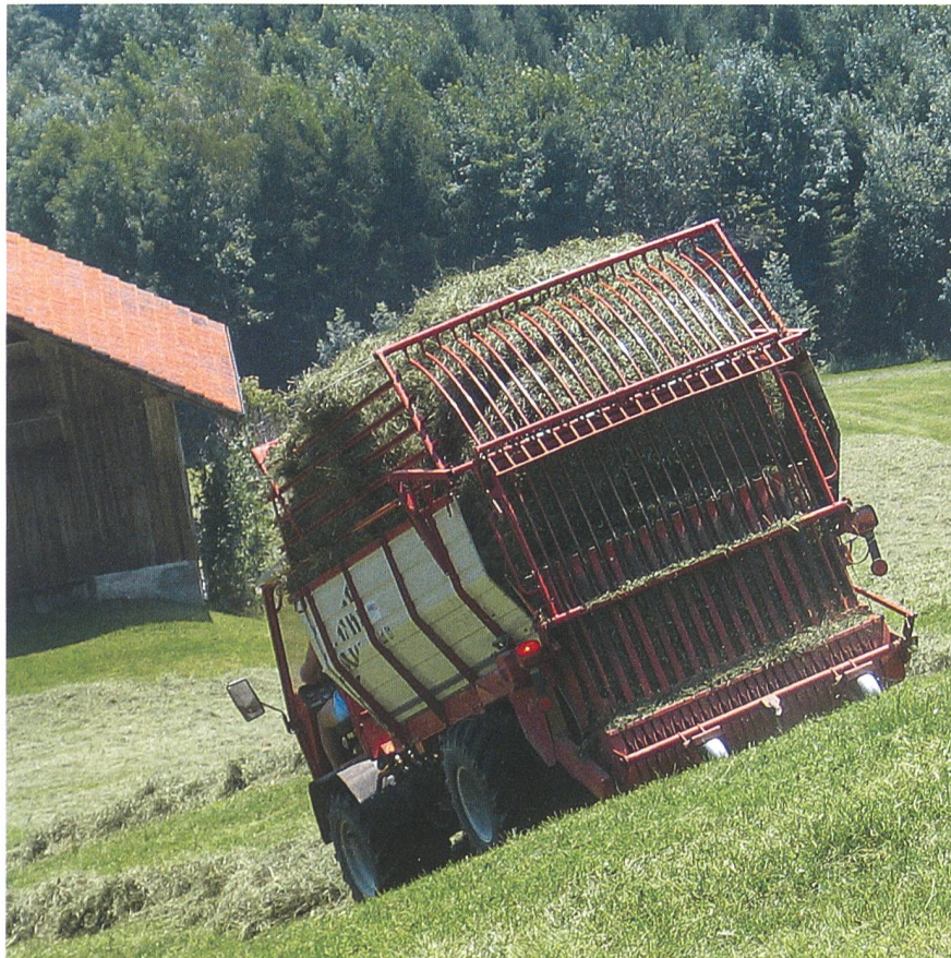
Beim Laden im Berggebiet sind die Schwaden der Topographie anzupassen. Dennoch bieten sich auch hier möglichst grosse Ladeschwaden an, um die Anzahl der Überfahrten zu reduzieren
