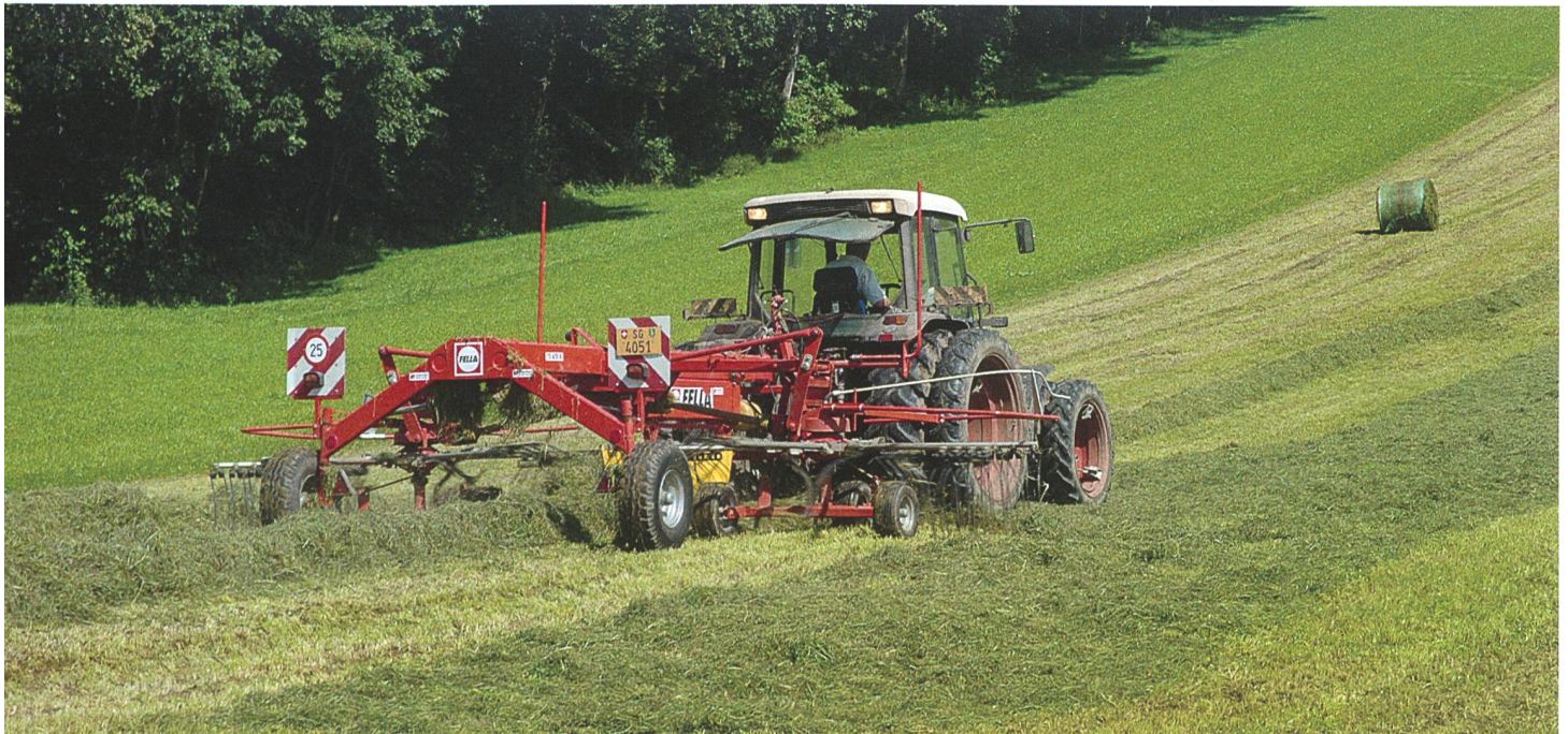
Der Doppelschwader zeigt seine Vorteile beim ersten Schnitt und grossen Aufwuchsmassen sowie im Berggebiet wegen seiner guten Spurtreue. (Bilder: ART)
