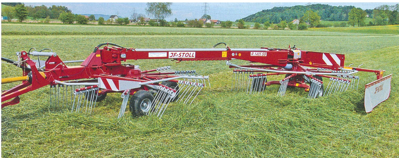
Der Seitenschwader ist ideal für kleinere Traktoren geeignet. Er zeigt seine Vorteile insbesondere bei geringen Aufwuchsmassen.
