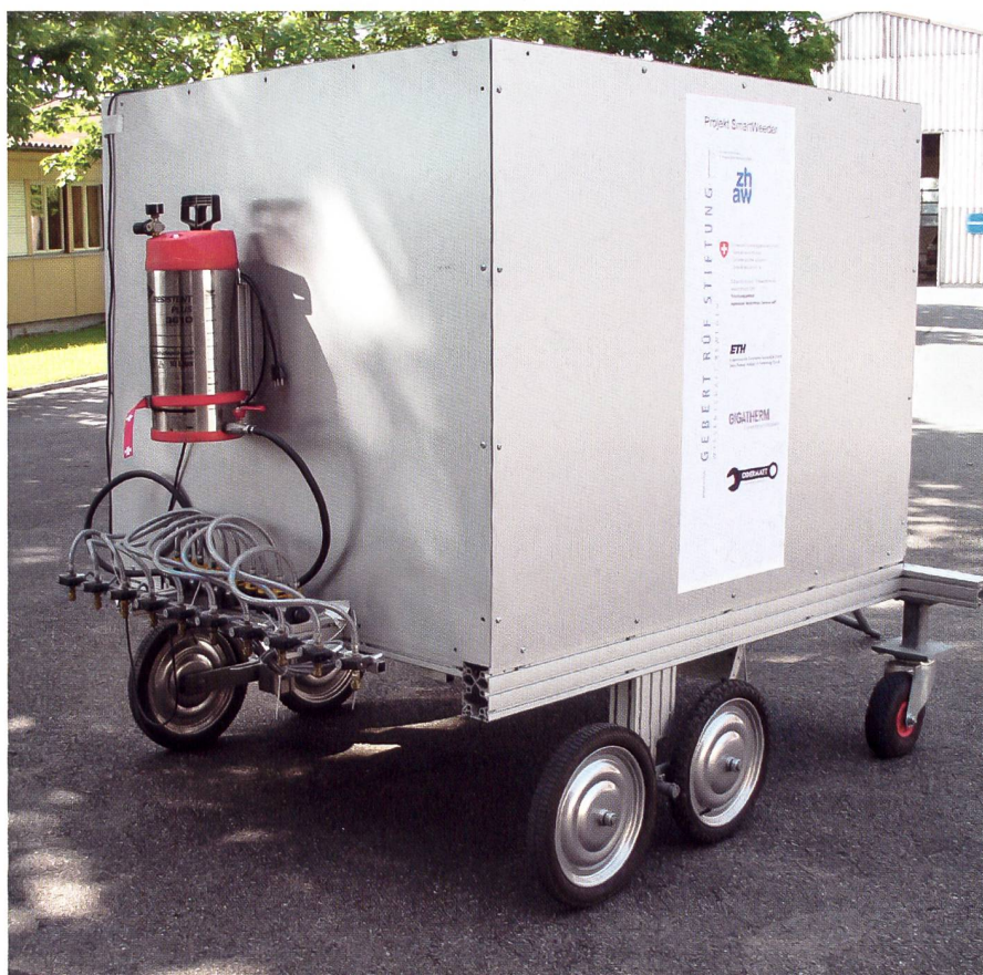
Abb. 1. Versuchsfahrzeug mit Kasten für die Bilderkennung/Elektronik und angebautem Präzisionspflanzbalken
