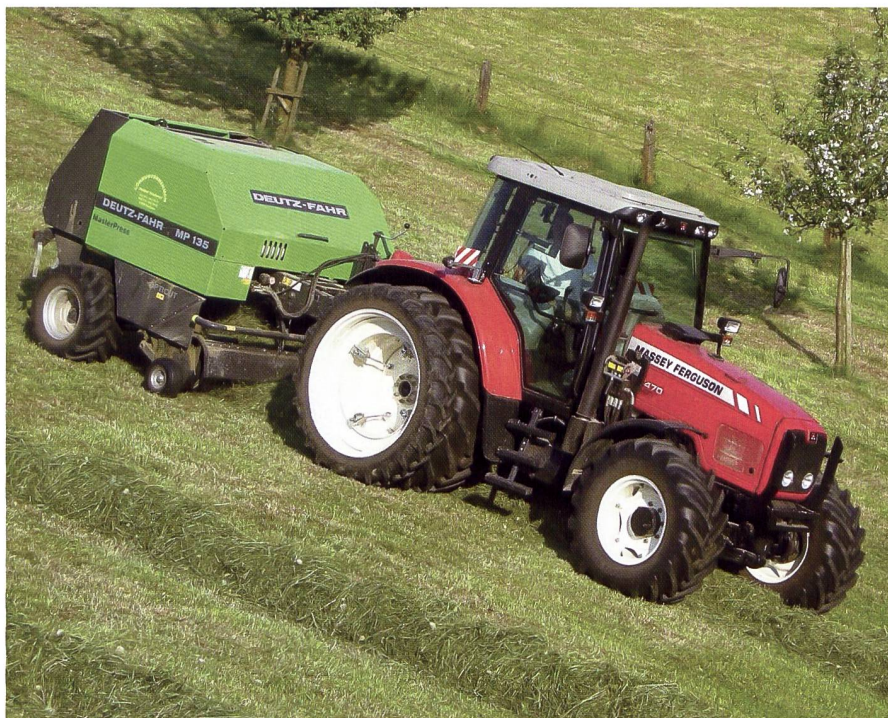
Standardtraktor mit Doppelrädern und AS-Bereifung an der Arbeitsmaschine für eine verbesserte Standfestigkeit beim Pressen am Hang.
