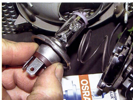
Nur bei Scheinwerfer-Glühbirnen muss darauf geachtet werden, dass der Glaskolben nicht berührt wird, bei den Schlusslichtern ist dies nicht von Bedeutung.
