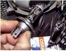
Nur bei Scheinwerfer-Glühbirnen muss darauf geachtet werden, dass der Glaskolben nicht berührt wird, bei den Schlusslichtern ist dies nicht von Bedeutung.
