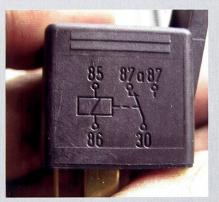
Schaltbild mit Kennzeichnung der Kontakte im Relaisgehäuse eingeprägt.
