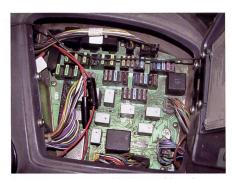
Die Sicherungen und Relais sind bei diesem Traktor (Deutz-Fahr Agrotron) in der gleichen Leiterplatte eingesteckt. Die Relais erkennt man an ihren würfelförmigen, hellen oder dunkeln Kästchen. Die Kennfarbe der Sicherungen steht für eine bestimmte Amperezahl, diese ist bei Flachstecksicherungen aufgedruckt (z. B. 10 Amp.).
