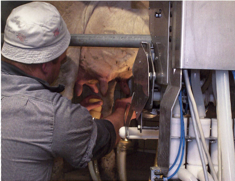
Jeder Zitzenbecher hat seinen eigenen Zuführschlauch. Das Halten des Melkzeugs entfällt. (Fotos: mo, zvg)
