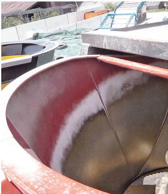
Der Behälterrand darf max. 8 cm breit sein, so dass Futterreste herunterfallen. Mit der Massnahme wird verhütet, dass jemand leichtsinnig auf den Behälterrand steigt.
