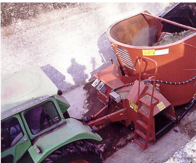
Entweder ist die Sicht zum Entnahmebereich vom Fahrerplatz aus durch die perforierte Frontwand gewährleistet oder...
