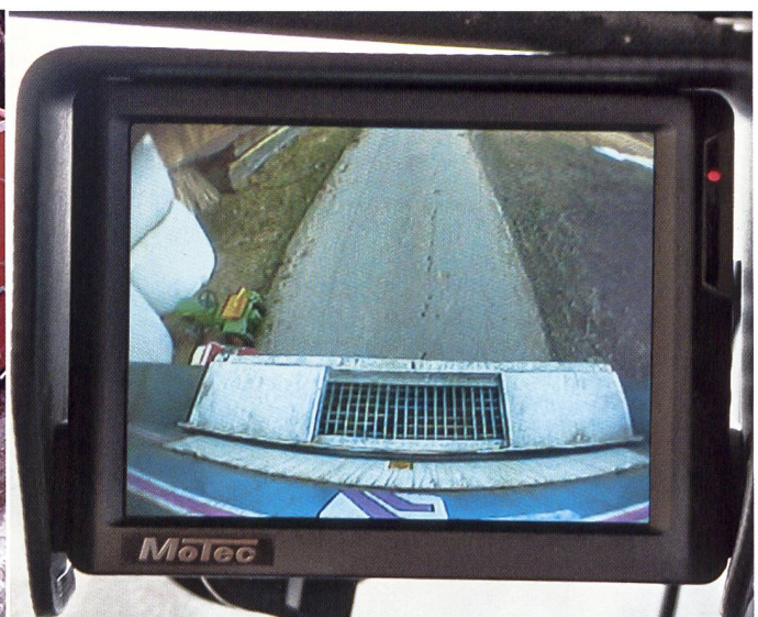
... sie wird durch ein Kamerasystem sichergestellt. Die Kamera ist zu bevorzugen, da sie beim Manövrieren zusätzlich mehr Sicherheit bringt.
