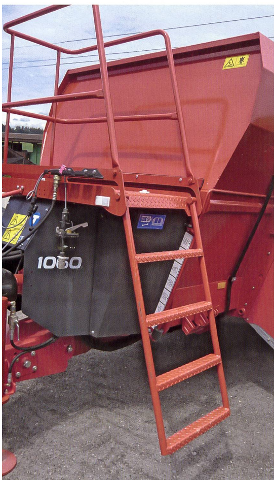
Die Plattform ermöglicht die Kontrolle des Mischvorganges aus sicherer Distanz. Um das unüberlegte Einsteigen zu erschweren, muss die Plattform mindestens 1.20 m tiefer liegen als der Behälterrand.
