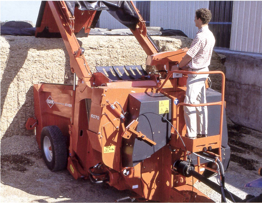
Zweihandbedienung und Totmann-Prinzip: Eine Hand betätigt den Schneidschild, die andere senkt den Arm. Beim Loslassen stoppt die eine oder andere Funktion. Diese technische Massnahme zwingt dazu, Hände und Arme vom Gefahrenbereich fernzuhalten. (Foto: Kuhn)
